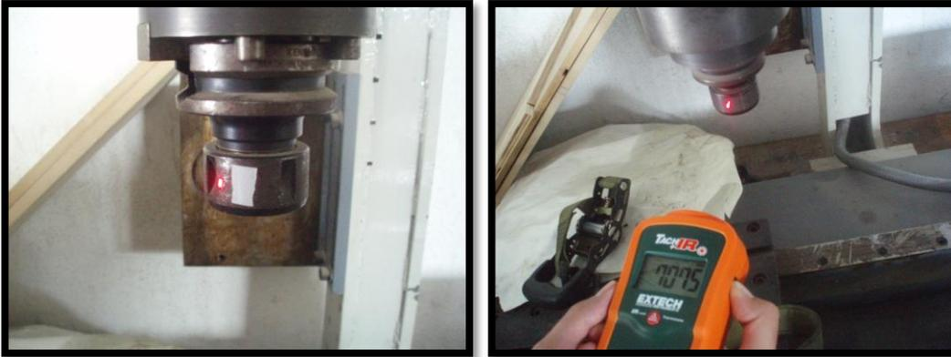
Figura 51. Tacómetro digital en prueba reflectiva.
