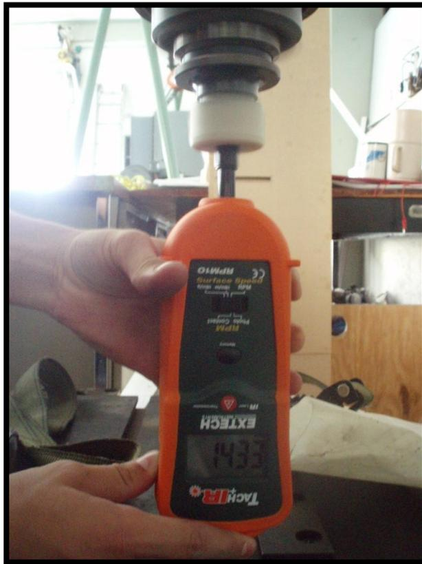
Figura 50. Tacómetro Digital en prueba por contacto.
