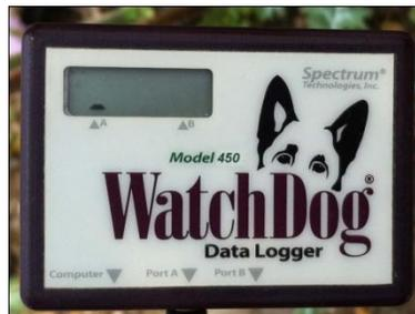
**Figura 4.8.** Data logger utilizados para medir temperatura y humedad
