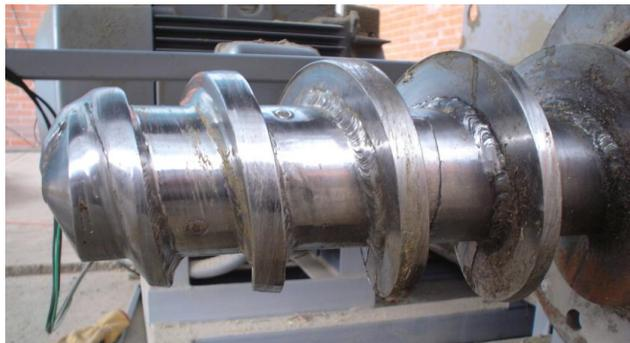
Figura 13. Desgaste presente después de una producción de 12 toneladas
