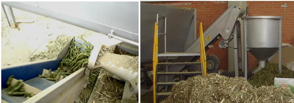
Figura 7. Transporte y enfriamiento de pellets
