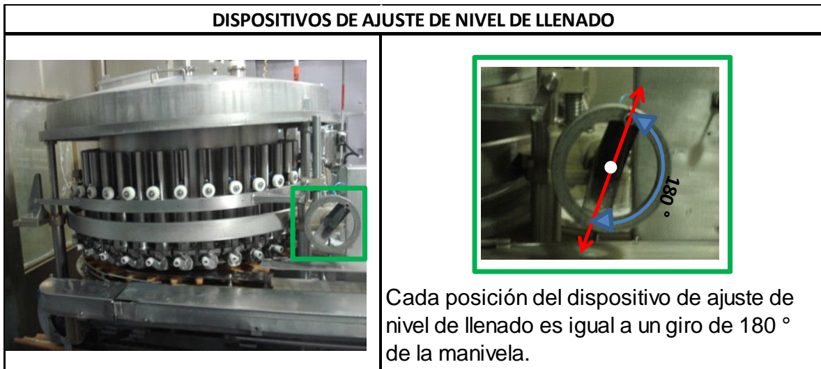
Figura 13 Dispositivo de ajuste de nivel de llenado
