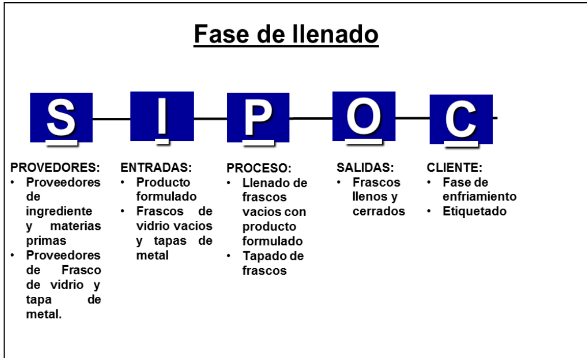
Figura 5 Diagrama SIPOC para la fase de llenado
