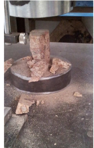
Figura 70. Falla presentada por la probeta #3 (Saturada)
