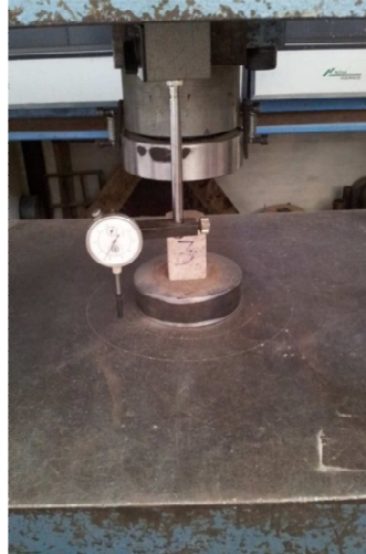
Figura 69. Colocación de muestra en máquina universal.
