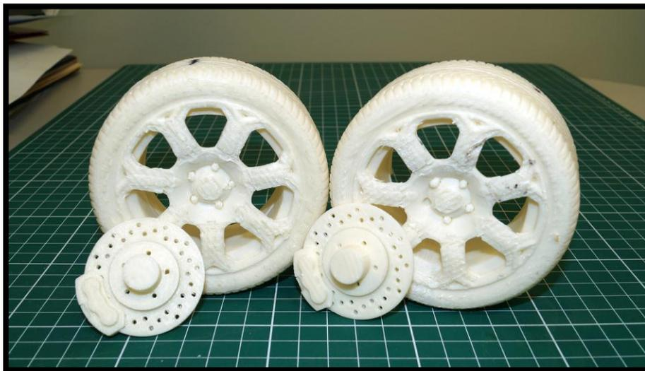
Figura 45. Volumétrico de llanta, rin y horquilla escala 1:5 mediante proceso de manufactura aditiva (impresión 3D).
