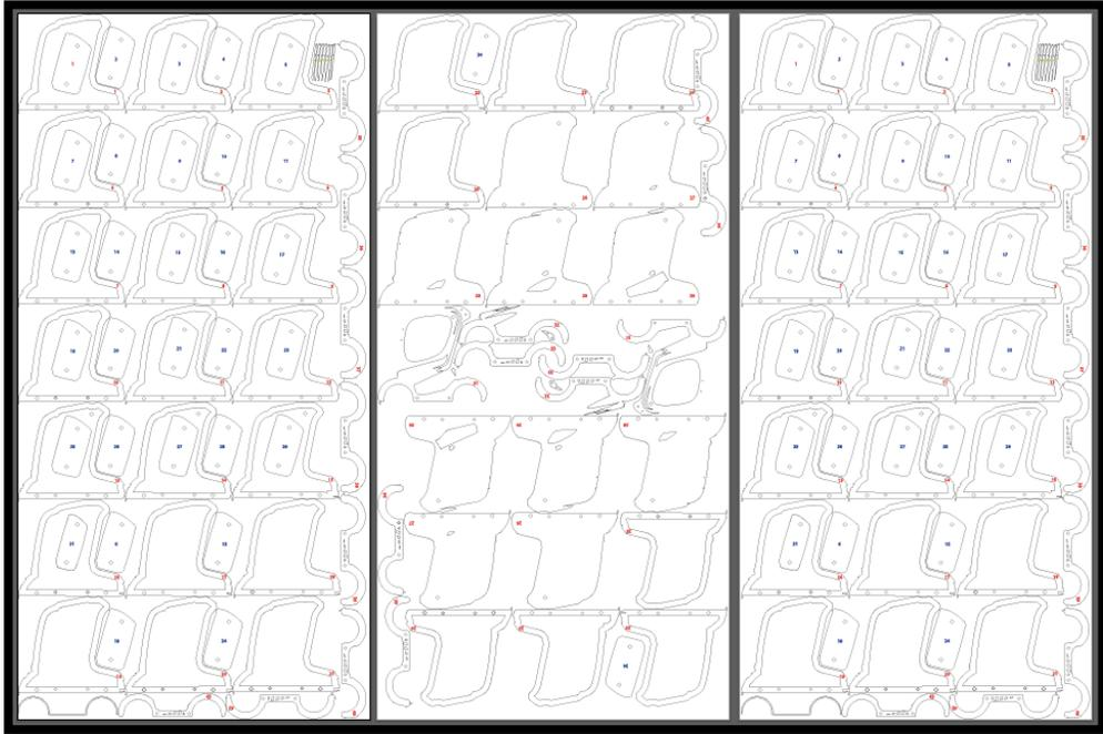
Figura 38. Distribución espacial de planos seriados para corte láser CNC, sobre MDF 3 mm.
