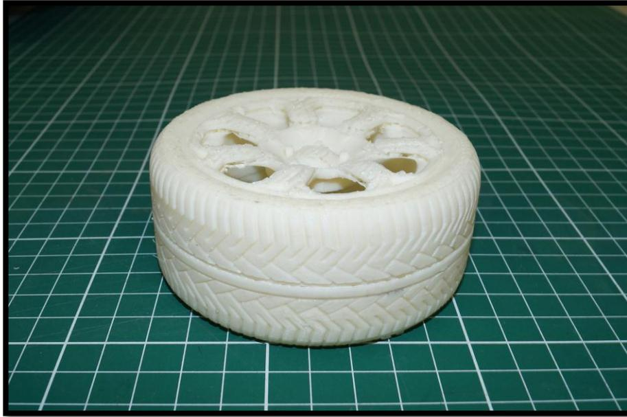
Figura 44. Volumétrico de llanta y rin escala 1:5 mediante proceso de manufactura aditiva (impresión 3D).
