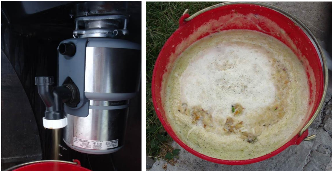
Imagen 100.- Izquierda: Expulsión de los residuos triturados Derecha: Residuos obtenidos antess de la colación.
