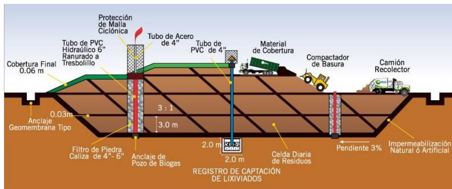
Imagen 22 – Funcionamiento de un Relleno Sanitario
