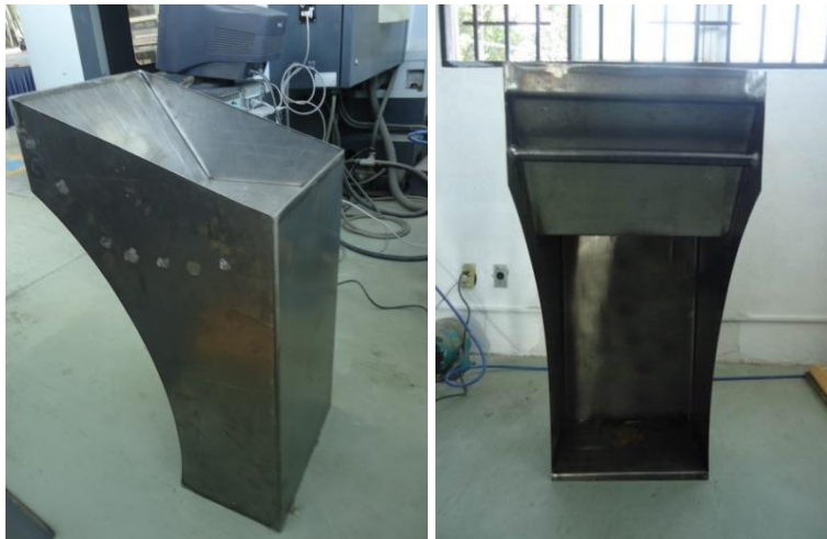
Imagen 90.- Estructura resultante del proceso de soldadura.
