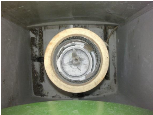
Imagen 61.- Interior del contenedor, mostrando la adaptación del sistema de aspas
