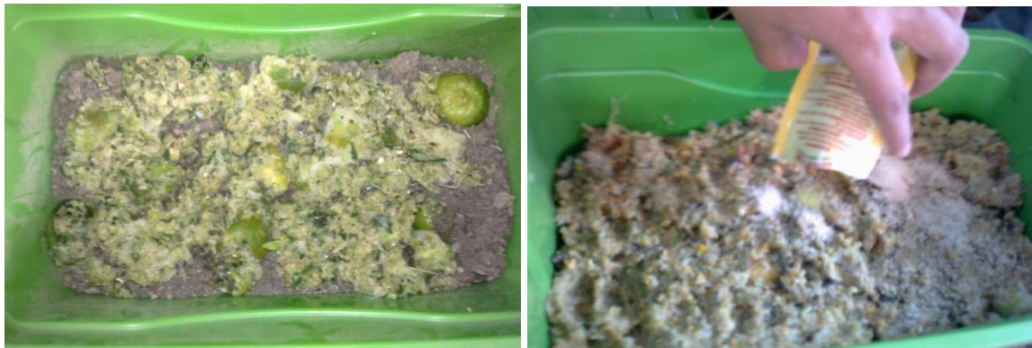
Imagen 81.- Colocación de los residuos en los recipientes de prueba y aplicación de las enzimas
