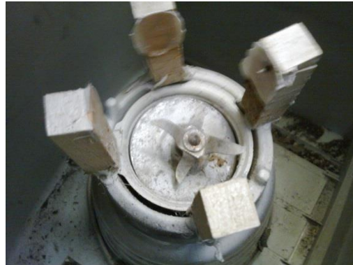
Imagen 61.- Interior del contenedor, mostrando la adaptación del sistema de aspas
