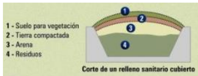
Imagen 21.- Capas de un Relleno Sanitario
