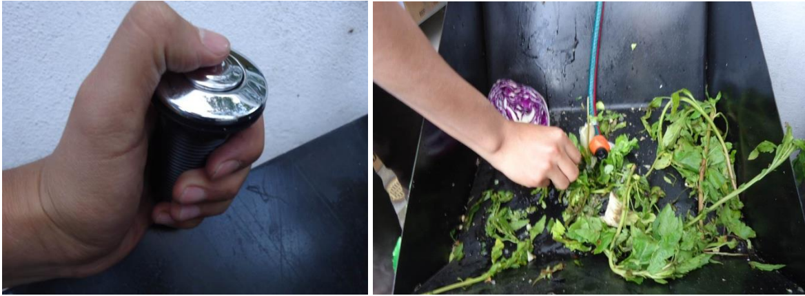
Imagen 99.- Izquierda: Encendido del proceso de trituración Derecha: Introducción de los residuos en el contendor
