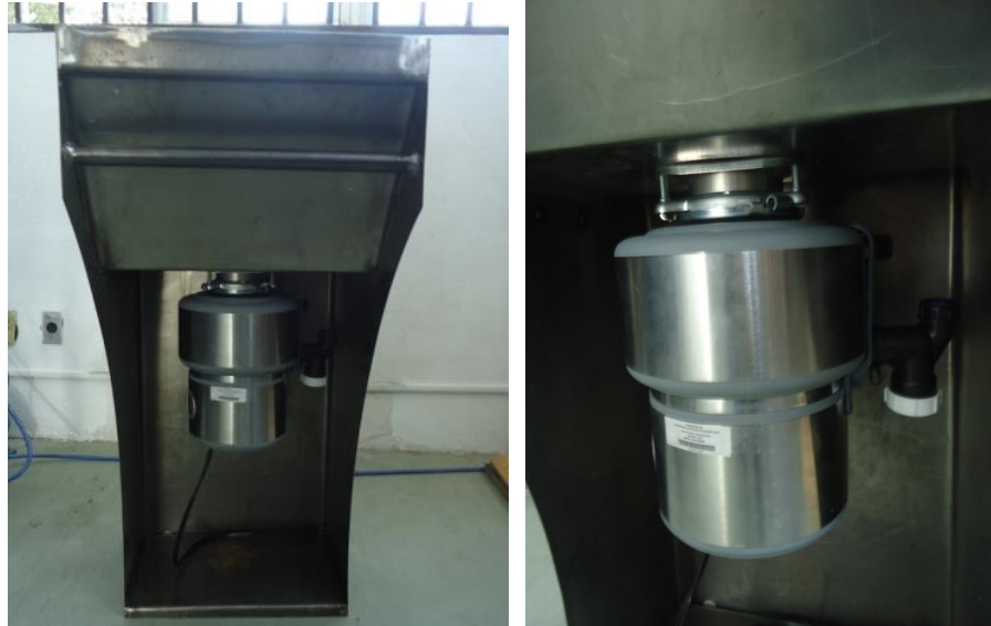
Imagen 91.- Inclusión de triturador en la estructura
