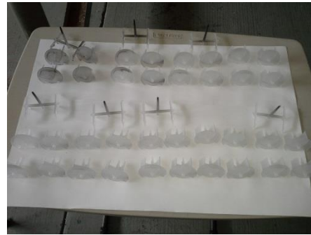
Figura B.1 a) Moldeo de pieza sin haber purgado la máquina con compuesto de purga.
