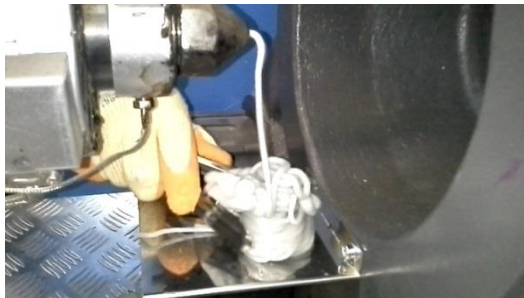
Figura B.2 Evacuación de material al momento de purgar el barril de la máquina.
