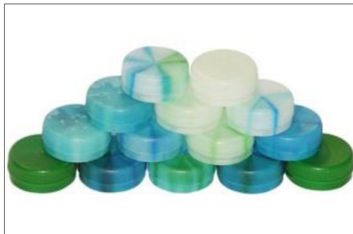
Figura 2.11. Ejemplo de desperdicio generado en una etapa de transición de material (cambio de color) en un proceso de moldeo.
