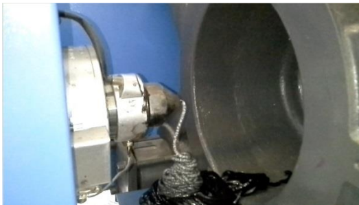
Figura B.2 Evacuación de material al momento de purgar el barril de la máquina.
