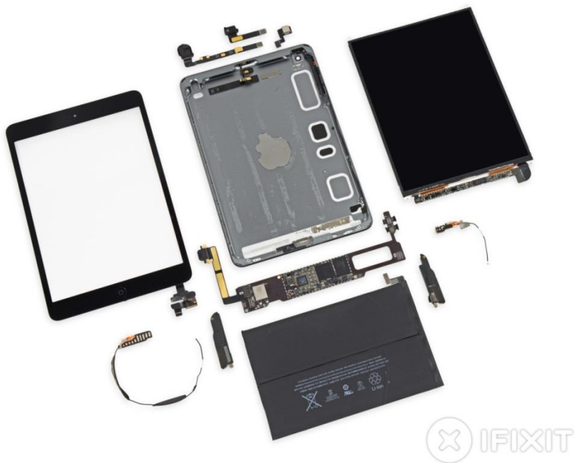
Imagen34. Componentes iPad mini (ifixit.com)
