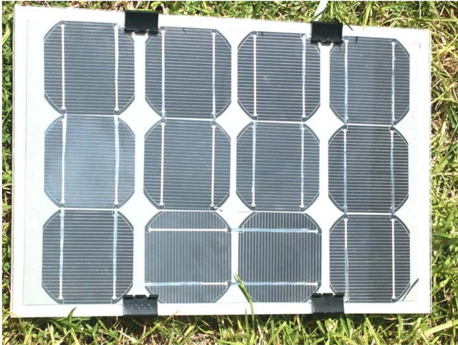
Fig. 3.2.1. Panel fotovoltaico de 10 W de construcción propia.
