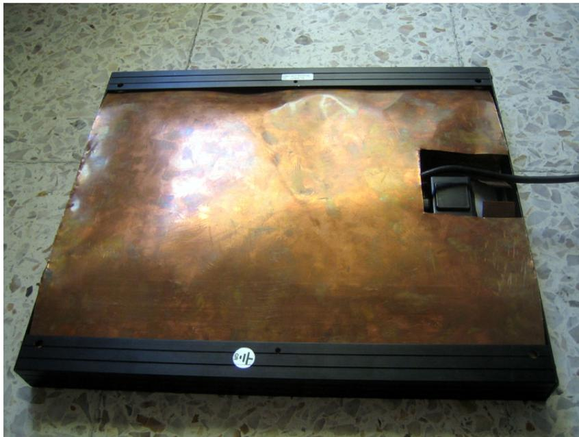
Fig. 3.2.2. Panel FV Siemens de 10W con el acoplamiento térmico de cobre.
