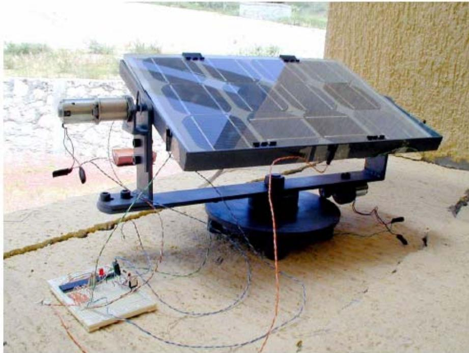
Fig. 2.1.3. Sistema de orientación de panel fotovoltaico a escala
