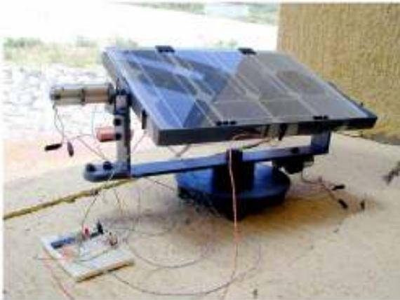
**Fig. 7. Sistema FV con orientación automática**
