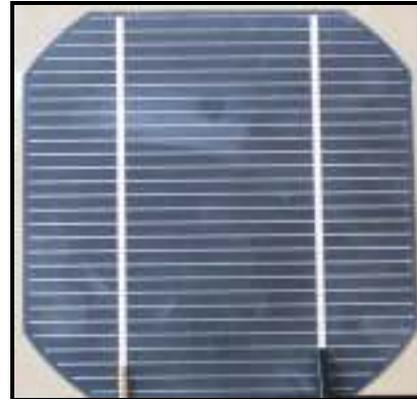
**Fig. 5. Celdas FV para construcción del panel FV**
