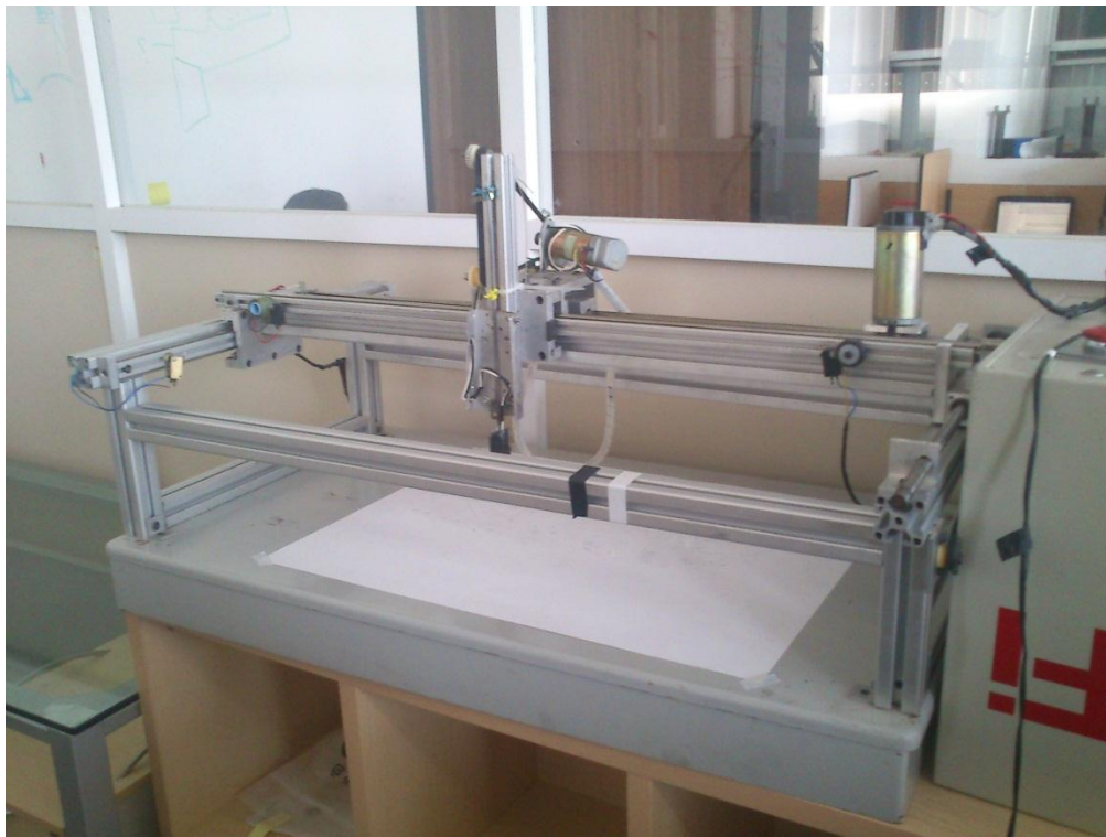
Figura 4.1. Mesa de coordenadas TX8.
