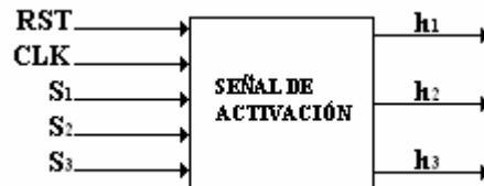
Figura 3.12.- Bloque lógico de la señal de activación.
