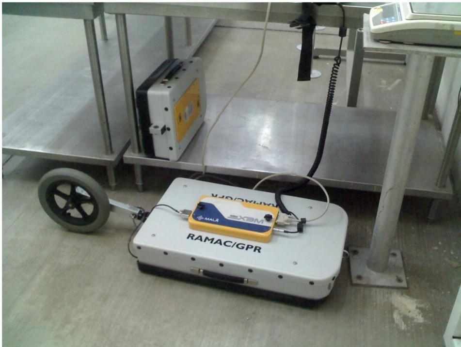
Foto 3. Antena de 250 MHz y 500 MHz
