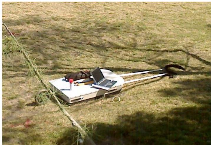
Foto 1. Equipo RAMAC/GPR utilizado para el estudio.
