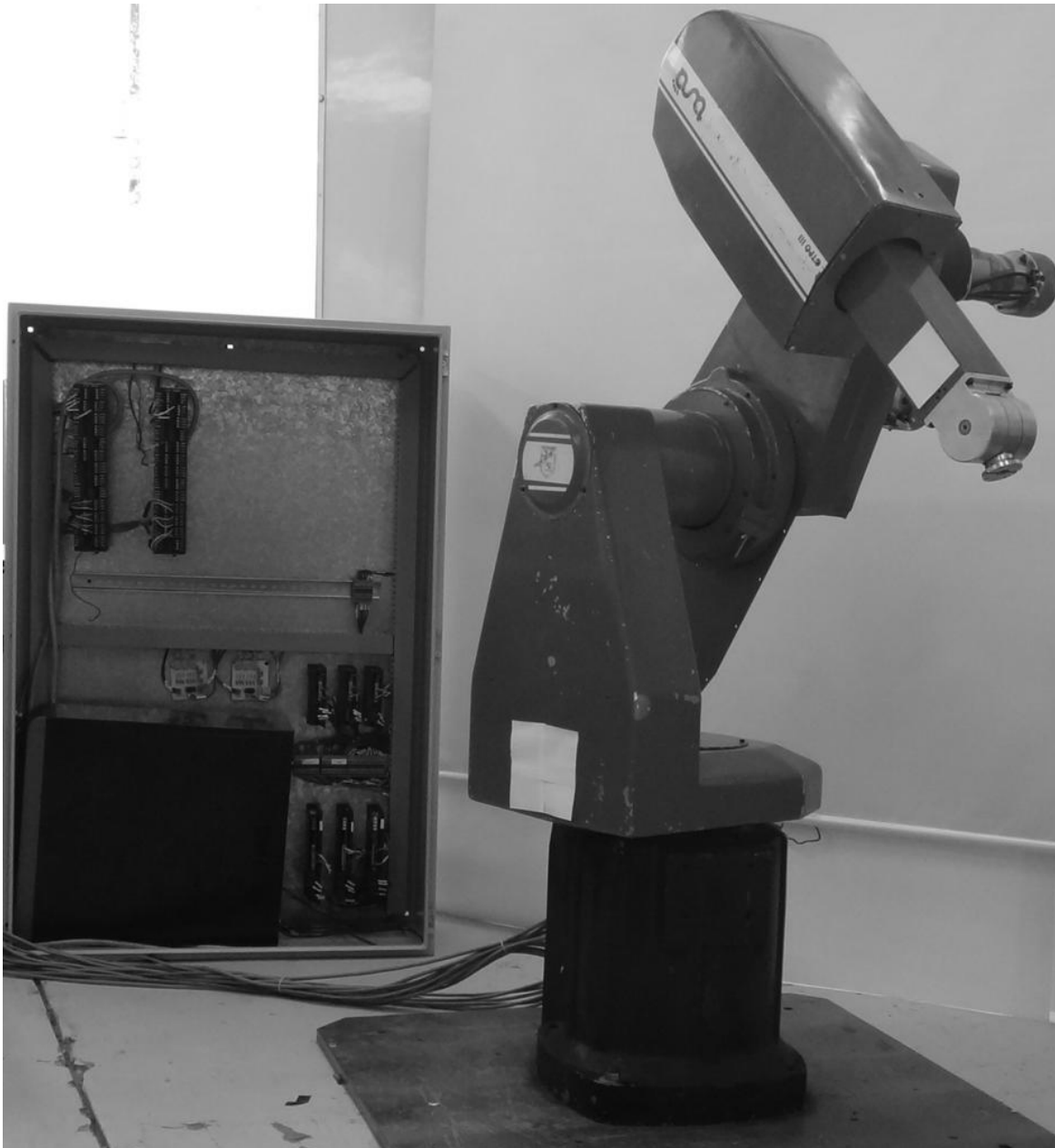
Figura 15. Robot industrial (Romat 56).
