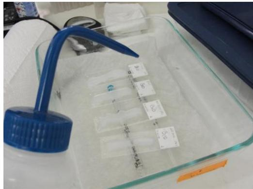
Figura 7. Cámara húmeda. En la imagen se muestra una cámara húmeda de vidrio. Después de cada lavado se le colocó una tapa para mantener húmedas las laminillas con los tejidos.
