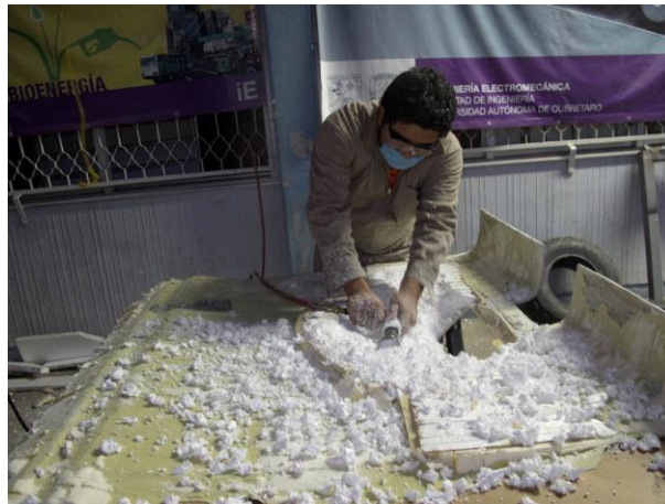
Figura 54 Eliminación de poliuretano y polietileno interior.
