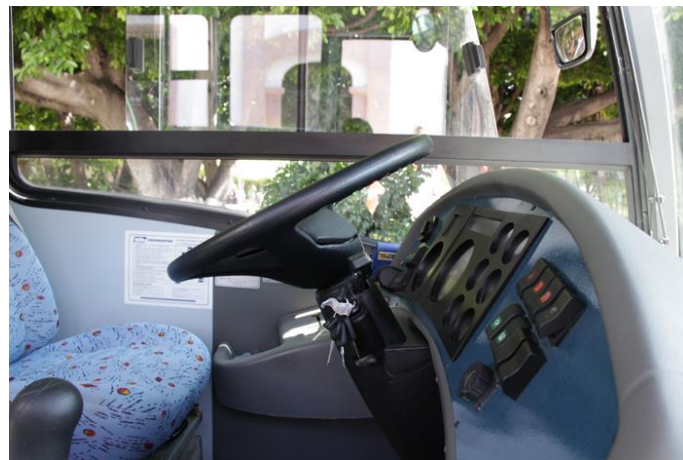
Figura 18 Autobús Urbano VW. Inclinación del volante
