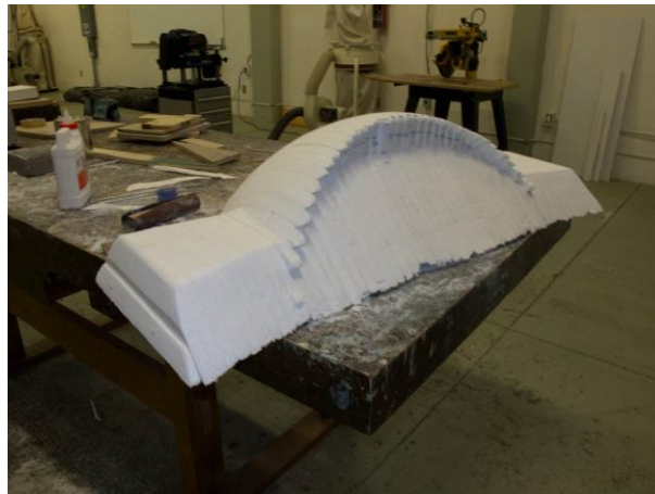
Figura 47 Tablero de instrumentos construidos en planos seriados
