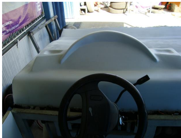
Figura 55 Montaje y colocación del tablero sobre la estructura.
