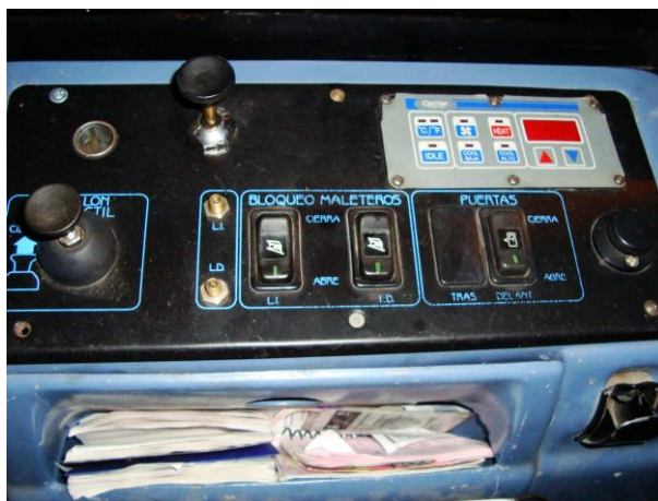
Figura 30 Panel de instrumentos lateral en autobús foráneo
