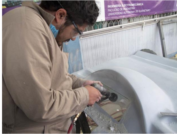
Figura 53 Perforaciones para colocación de pantallas.
