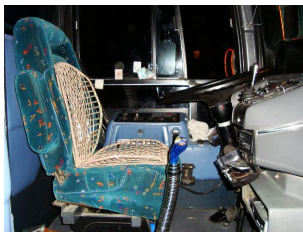
Figura 31 Adaptaciones al espacio del operador e inclinación del volante en autobús foráneo
