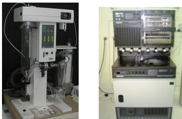
Figura 4. Secador Buchi Mini Spray Dryer B-191 (lado izquierdo) y Liofilizadora Labconco (lado derecho)
