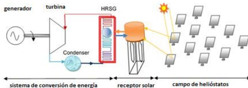
**Figura 1.3 Sistema típico de torre central.**
