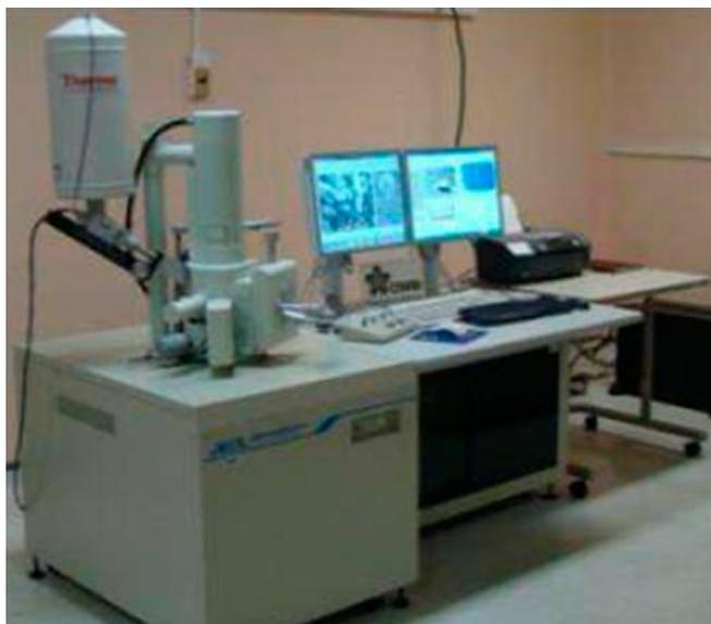
**Figura 3.6** Microscopio de barrido JEOL JSM-6390L
