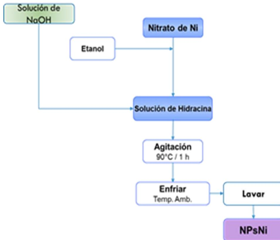
Figura 3.2 Diagrama de la síntesis de Ni
