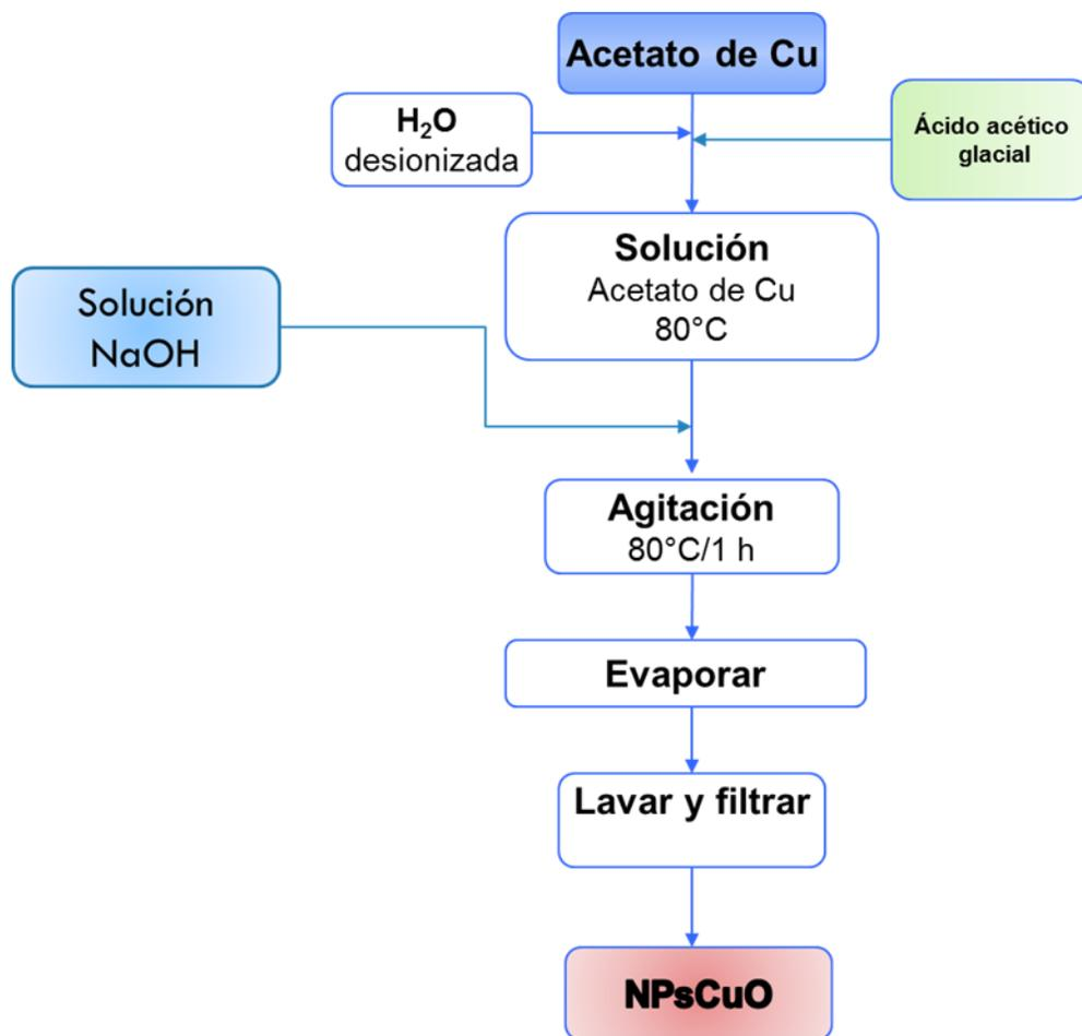
Figura 3.1 Diagrama de la síntesis de CuO
