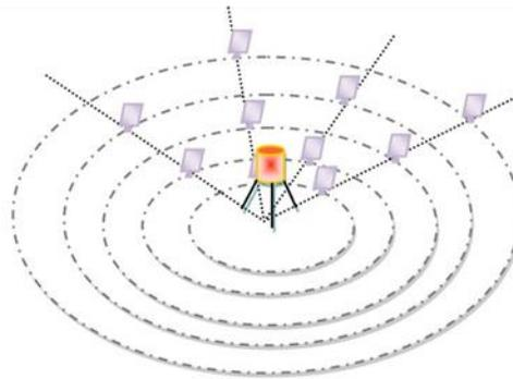
**Figura 1.2 Campo de helióstatos y colector solar de torre central convencionales.**
