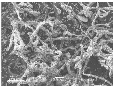
Figura 4.9 Imagen SEM de nanopartículas de Ni metálico.
