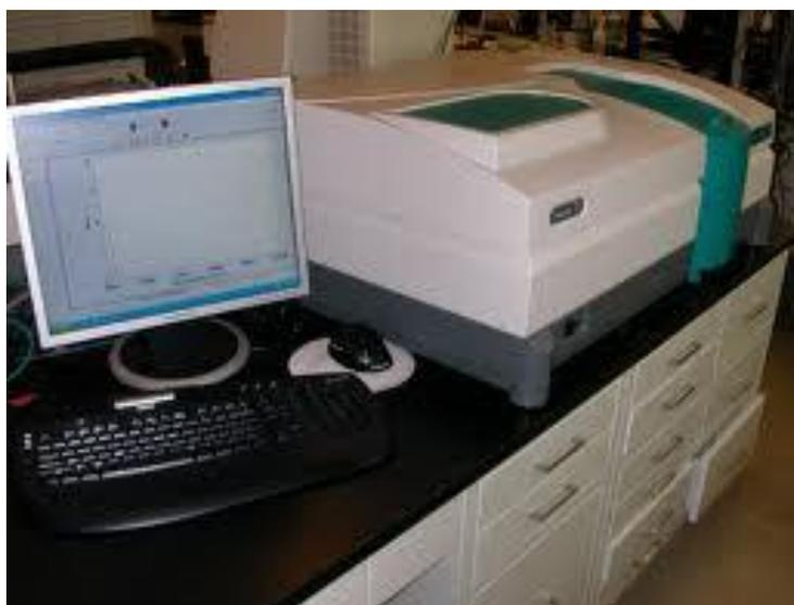
**Figura 3.3** Equipo de espectroscopía UV-Vis Varian Cary 3.
