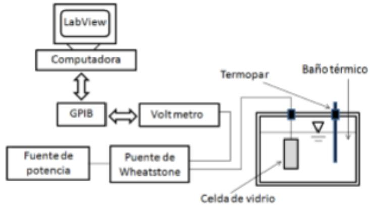
Figura 3.9 Diagrama de funcionamiento del método transitorio de hilo caliente, laboratorio de conductividad térmica CENAM.
