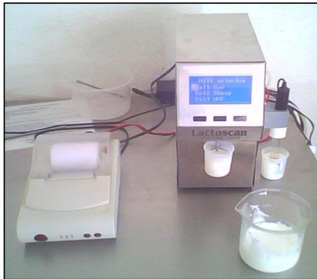
Figura 10. Analizador de leche (Lactoscan Milkanalyser SR60).
