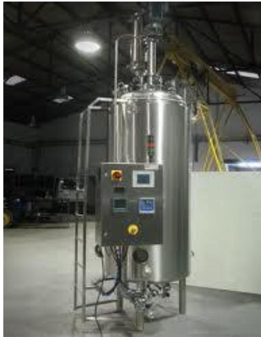
Figura 5. Fermentador usado en industrias farmacéuticas, alimenticias, bio-tecnológicas, piloto o de laboratorio.
