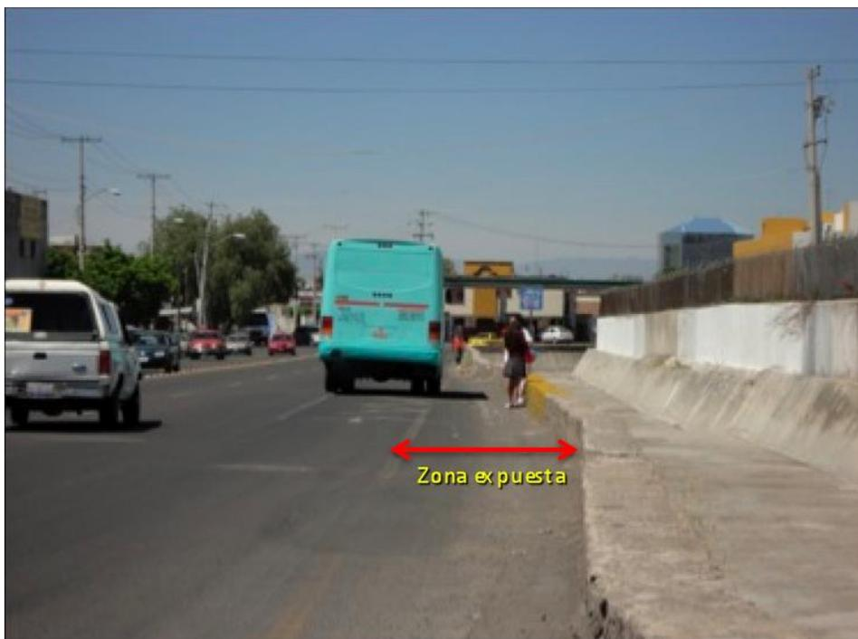
Figura 36 .- Falta de banqueta sobre el paradero, y la bahía insuficiente para que el autobús no interfiera con el tráfico del carril. Av. Candiles a un costado de San José de los Olvera.
