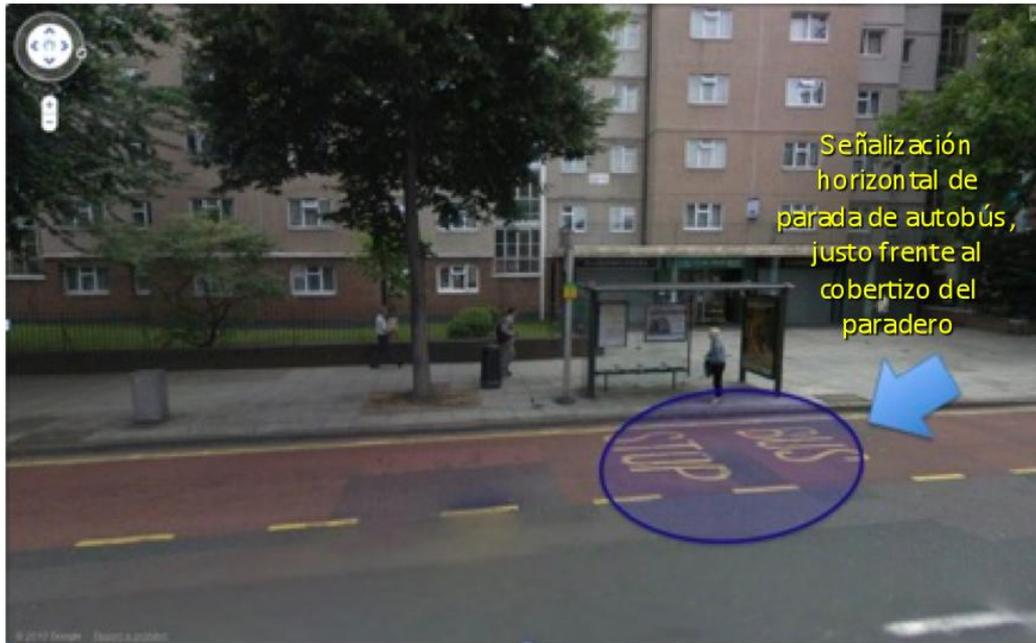
Figura 12 .- Área designada para las maniobras de abordaje y descenso de las unidades, pintada sobre el asfalto en la vía de circulación, ciudad de Londres, Inglaterra.
