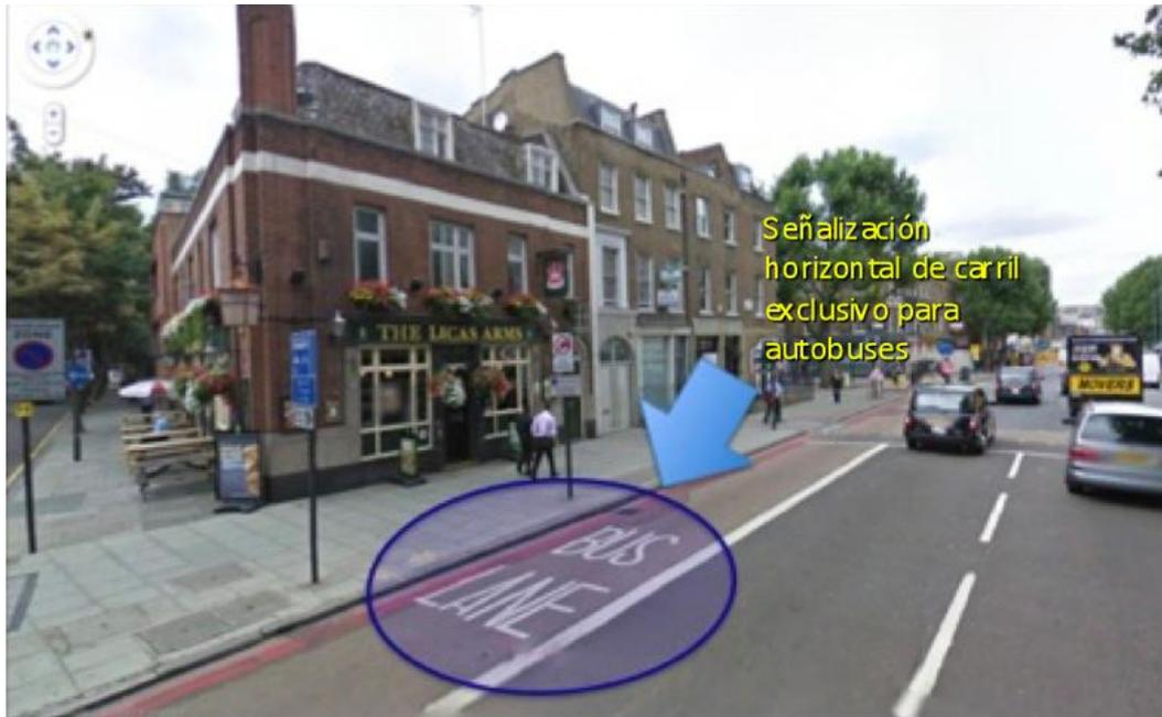
Figura 13 .- Área designada como carril exclusivo para el autobús, pintado sobre el asfalto de la vía de circulación, ciudad de Londres, Inglaterra.
