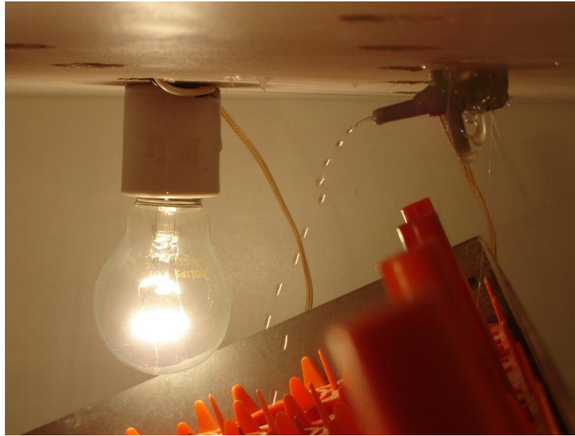
Fig.3.3.12 boquilla del humidificador en funcionamiento
