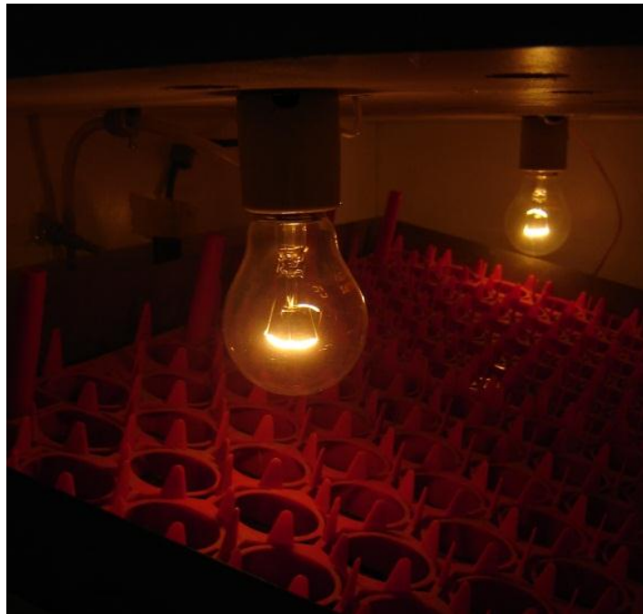
Fig. 3.3.11 intensidad variante de las bombillas con el pwm.
