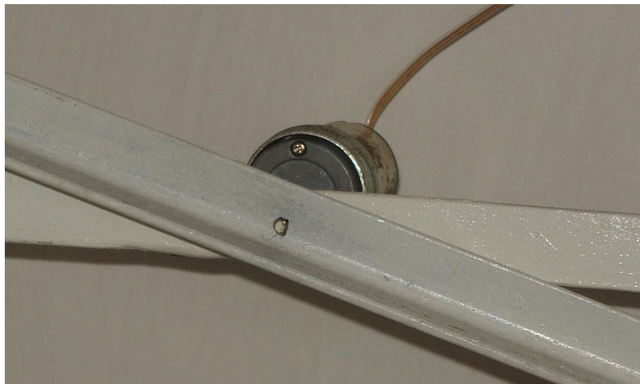
Fig.3.3.9. motor utilizado para la inclinación de las charolas
