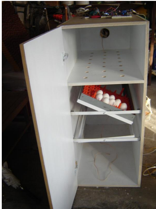
Fig.3.3.4. incubadora con las charolas para el volteo
