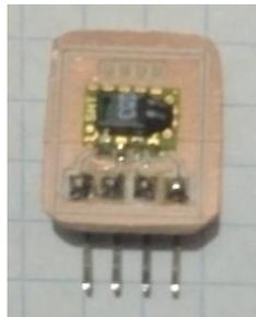
**Figura IV.8 Vista superior de la tarjeta para el sensor SHT11.**
