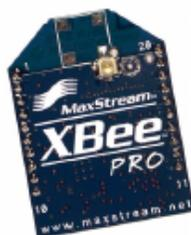
Figura II.13 Modulo ZigBee
