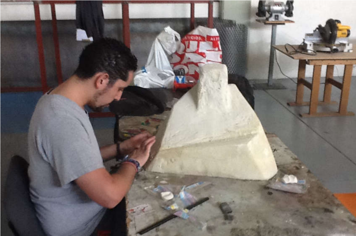
Figura 4.7 Realización de la parte inferior del molde con espuma de poliuretano y pasta para modelar.
