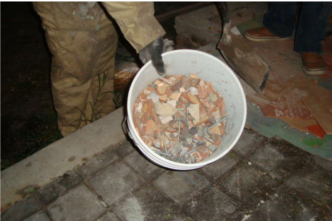
Figura 4.10. Mezcla de materiales ya triturados y pulverizados antes de la preparación del concreto.
