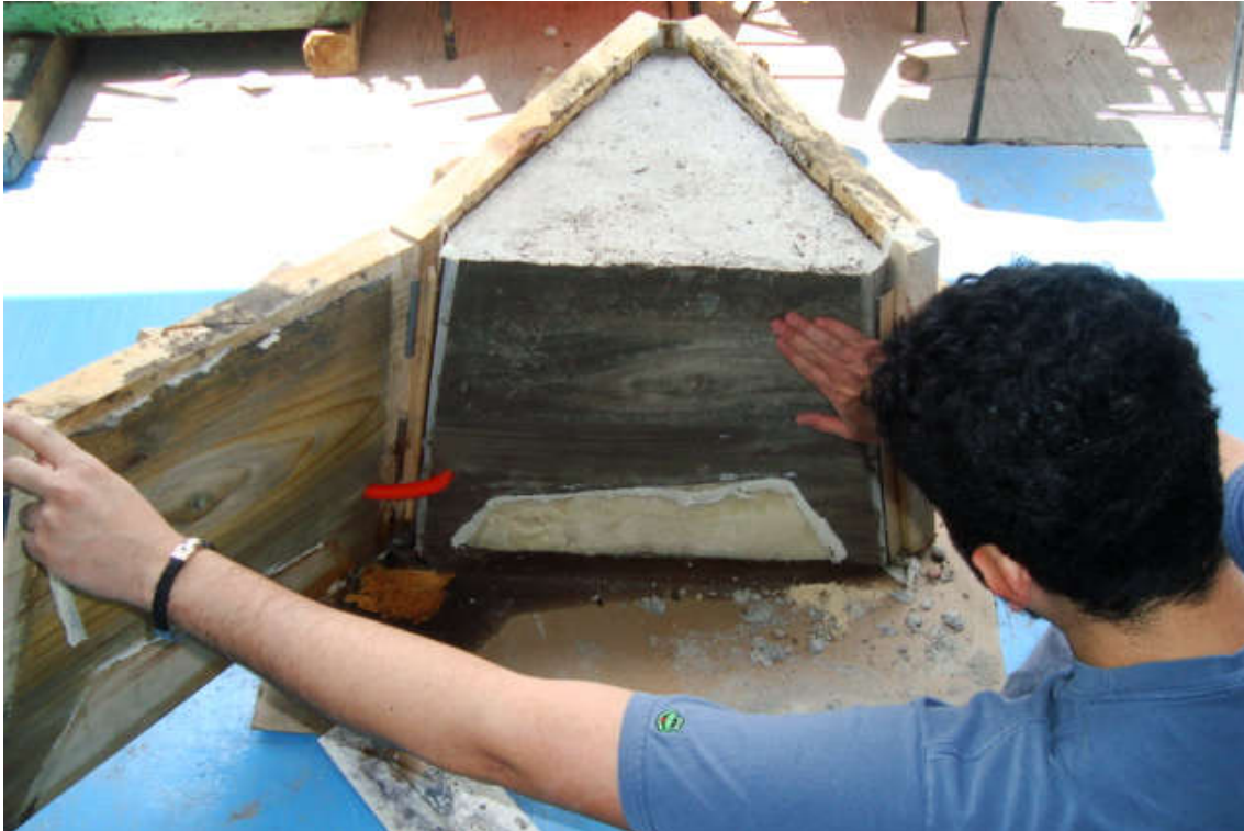
Figura 4.13. Apertura del molde después de 36 horas de fraguado.
