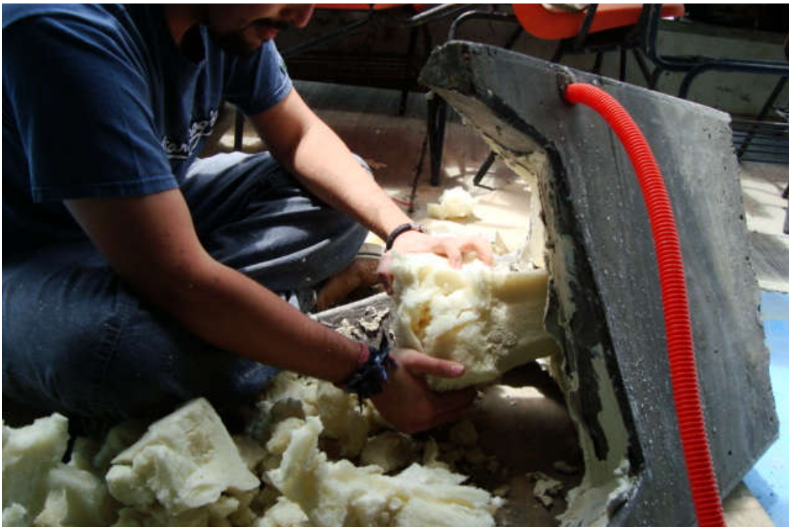
Figura 4.14. Retiro de la pieza inferior de espuma de poliuretano para liberar el molde.
