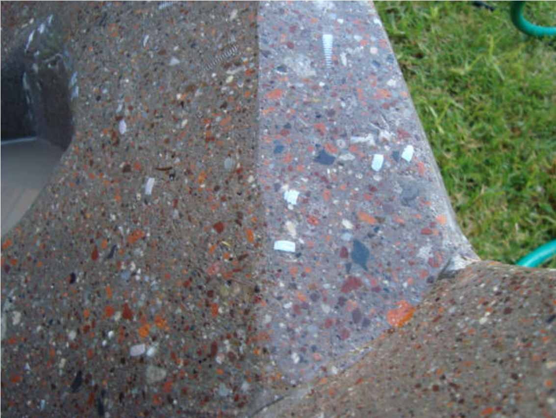
Figura 4.17. Detalle del material empleado una vez pulido el prototipo.
