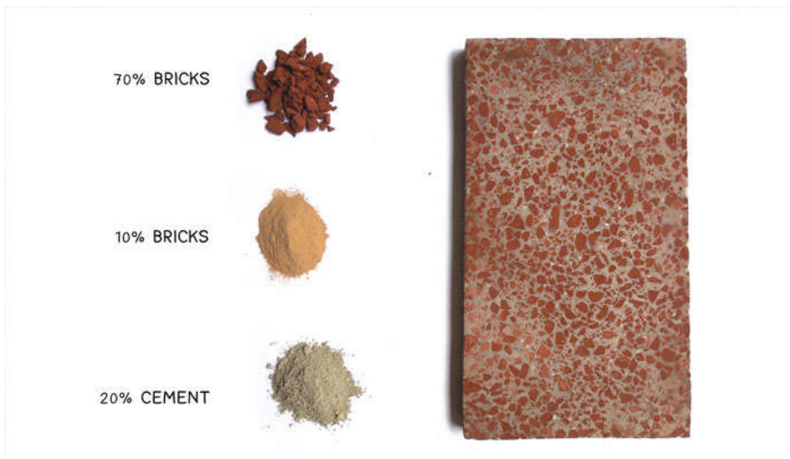
Figura 4.1. Descripción gráfica de los elementos que componen el Rubble Floor , utilizando un 70% de ladrillos triturados para sustituir a la grava, 10% de ladrillos pulverizados como colorante y 20% de cemento como material de cohesión entre todos los elementos.
