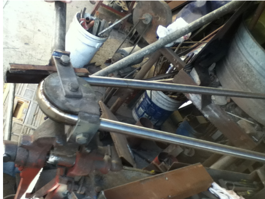
Ilustración 37 Rolado del tubular de acero inoxidable para los trapecios
