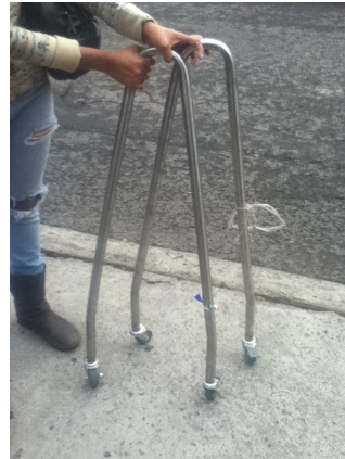
Ilustración 39 Trapecios con llantas instaladas
