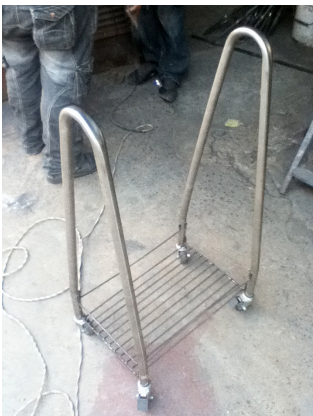
Ilustración 40 Canastilla inferior y varillas ensambladas a los trapecios
