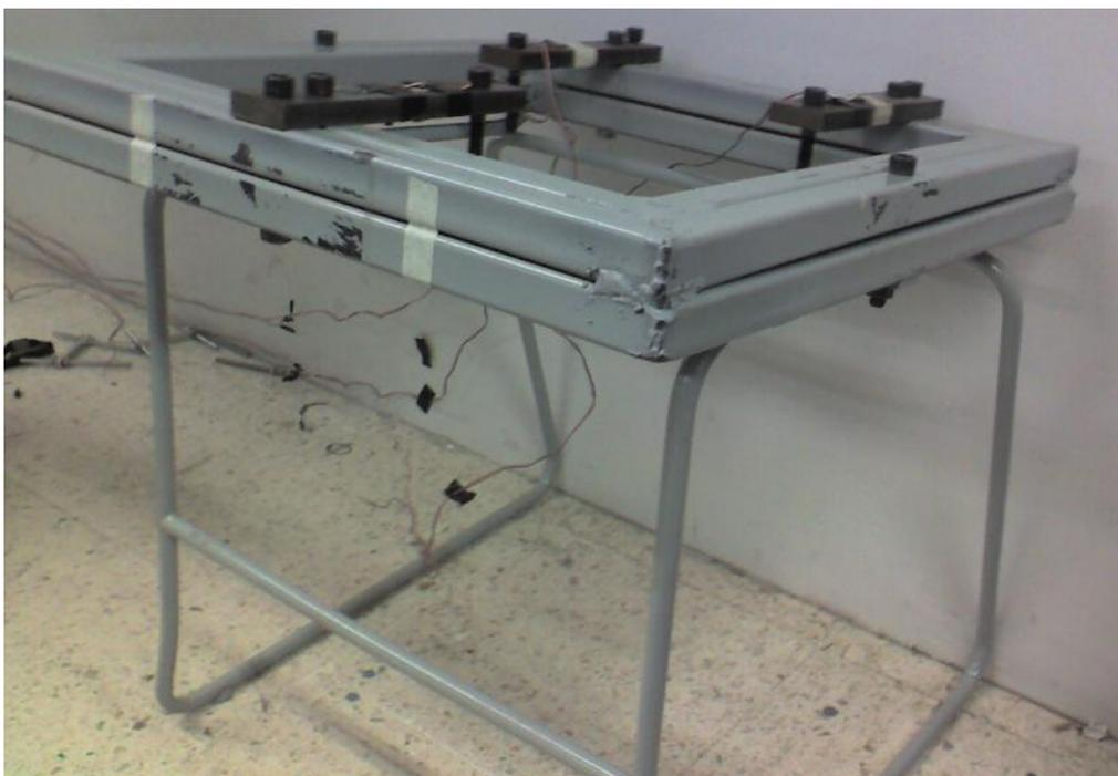
**Figura 29. Marco de carga colocado en la nueva base.**
