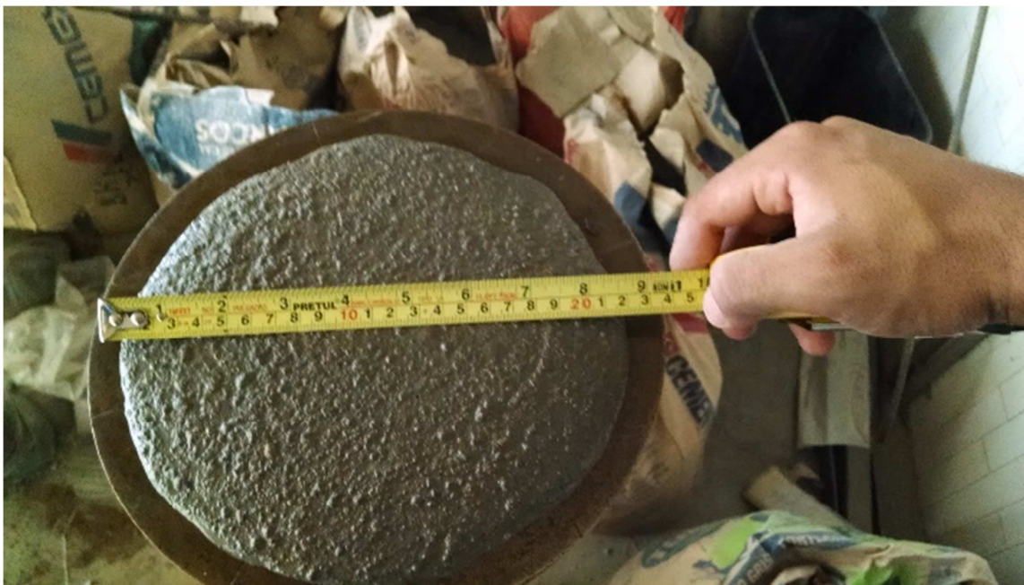
Figura 3.3. Ensayo para determinar el revenimiento.
