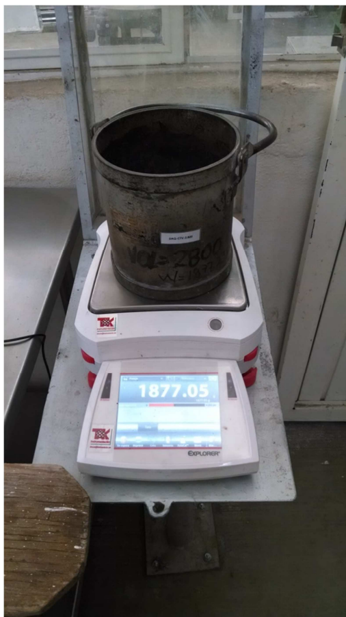
Figura 3.2. Calibración de recipiente.
