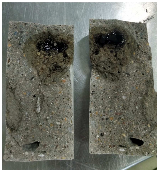
Figura 3.5. Punto frágil por el uso de fluidificante no homogenizado.
