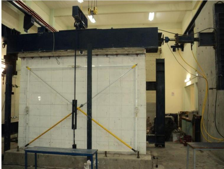
Figura 3.16 Sistema de carga utilizado para el ensaye de los muros.
