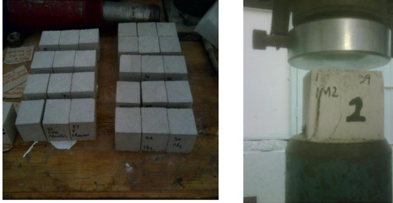
Figura A.2. Cubos y ensaye del mortero.
