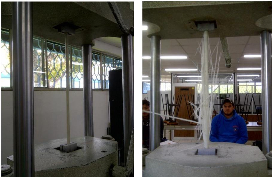
Figura A.4. Ensayo de las varillas de GFRP.
