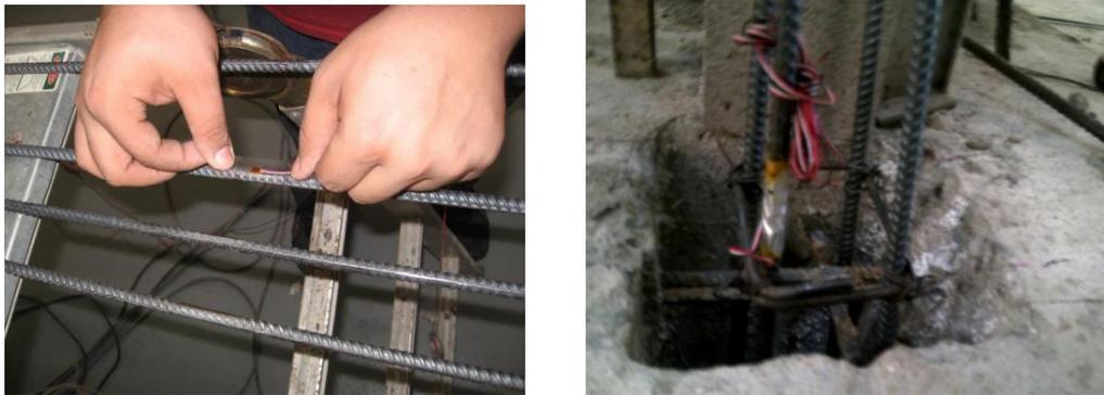
Figura 3.14 Instrumentación del acero en los castillos.
