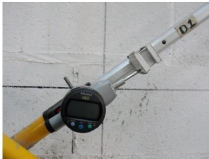
Figura 4.1. Detalle de barras diagonales.
