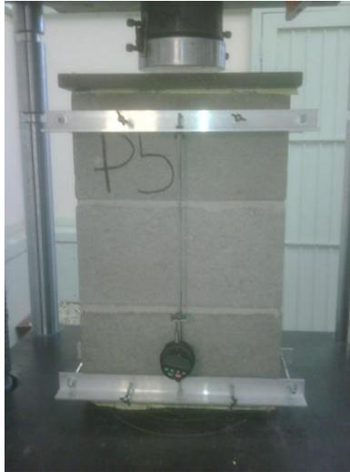
Figura 2.4. Pila para determinar la resistencia a compresión de la mampostería.
