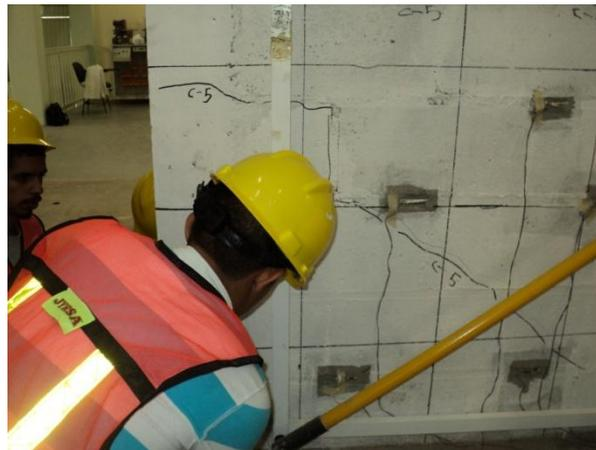
Figura 4.16. Primer indicio de daños del muro M2-CR.
