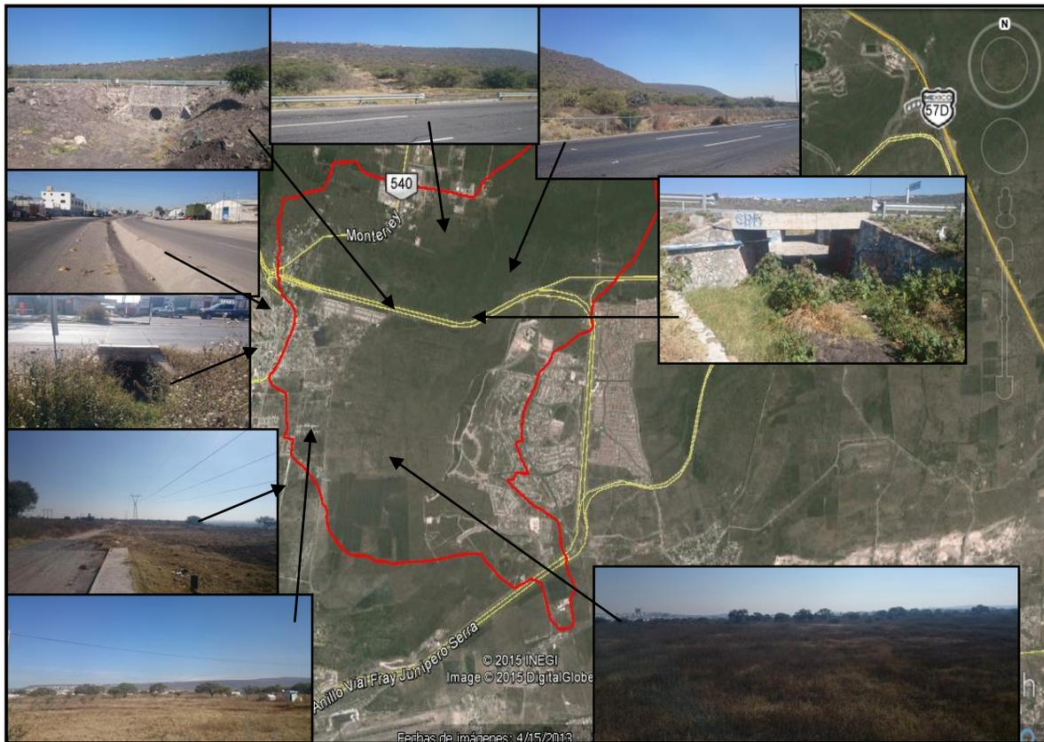
**Ilustración 7. Fotografías del recorrido de campo, justificando la delimitación de la cuenca y el uso de suelo.**
