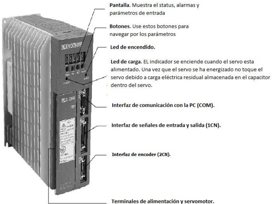
Figura 2.6. Servodrive de la marca Estun, serie EDB.
