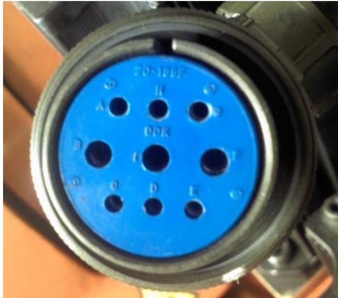
Figura 2.15. Conector hembra de cable de control para servomotores M4, M5 y M6.
