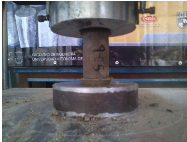
Figura 4.20 Ensayo a compresión simple de cilindros de concreto.
