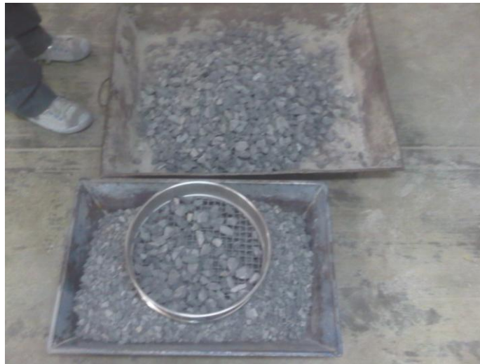
Figura 4.12 Proceso de Cribado de grava.
