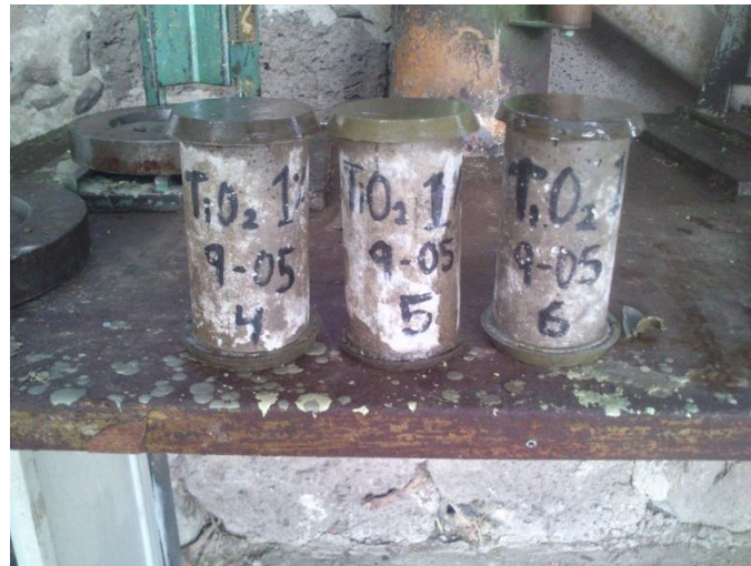
Figura 4.19 Cabeceado de cilindros de concreto con azufre.
