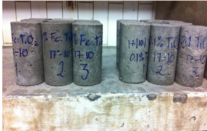
Figura 4.18 Curado de los cilindros de concreto.
