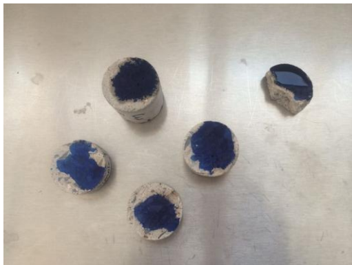
Figura 4.29 Manchado de concreto con azul de metileno.
