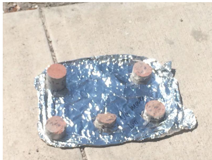
Figura 4.27 Exposición de concreto a la radiación solar segunda etapa (100ppm).
