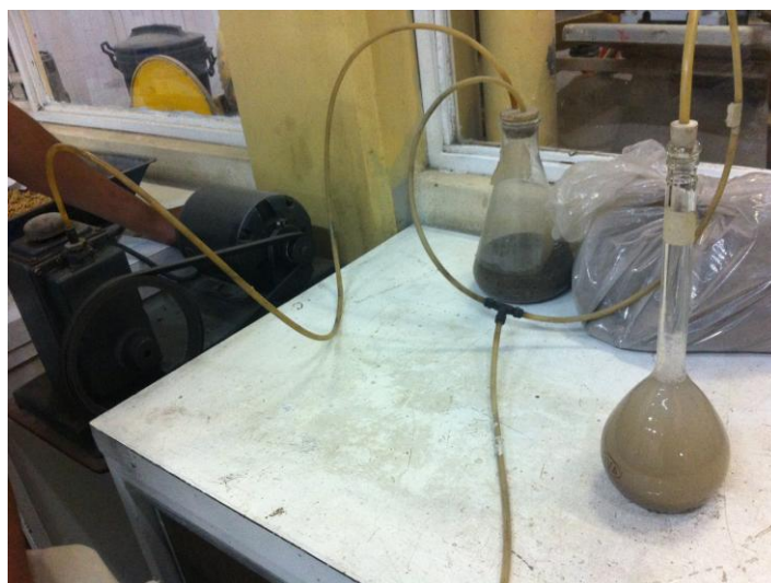
Figura 4.9 Proceso de extracción de aire mediante sistema de vacío.
