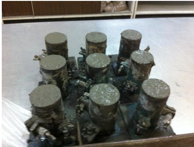
Figura 4.17 Colado de concreto en moldes cilíndricos de 5 cm de diámetro y 10 cm de altura.
