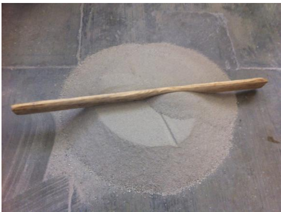
Figura 4.3 Proceso de cuarteo del agregado fino.
