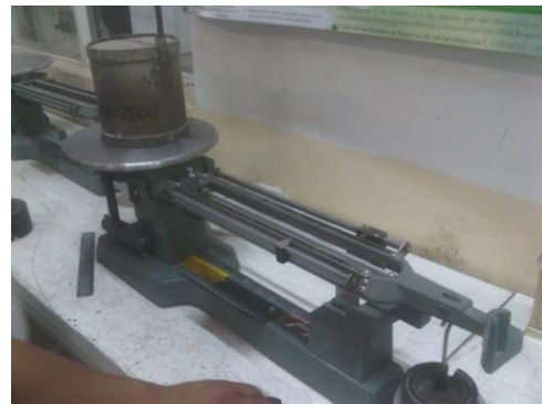
Figura 4.10 Proceso de obtención del Peso Volumétrico de la arena.
