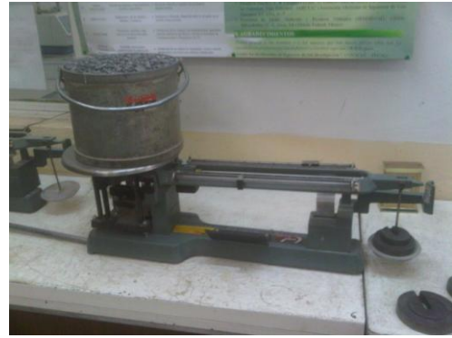
Figura 4.15 Proceso de obtención de los pesos volumétricos de la grava.
