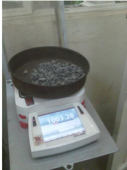
Figura 4.13 Obtención de testigos de humedad de grava.
