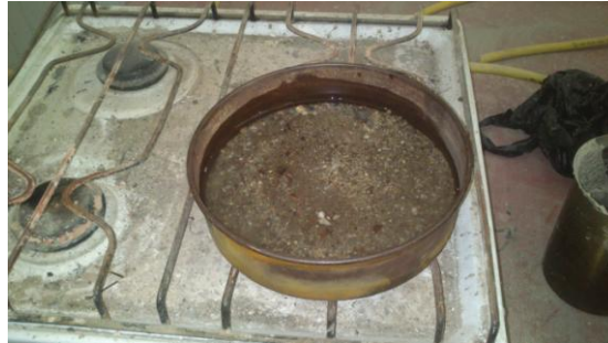
Figura 4.4 Saturación de arena durante 24 horas.
