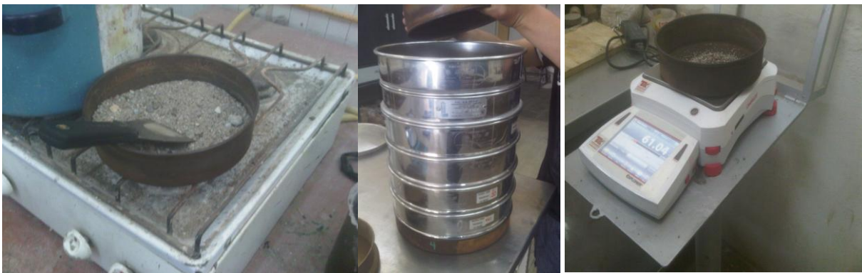
a) b) c) Figura 4.11 Proceso de obtención del Módulo de finura (Granulometría) .
