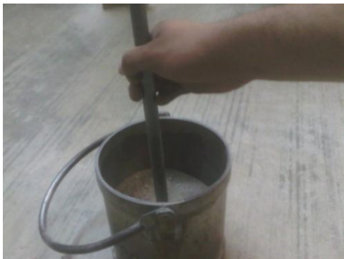
Figura 4.10 Proceso de obtención del Peso Volumétrico de la arena.
