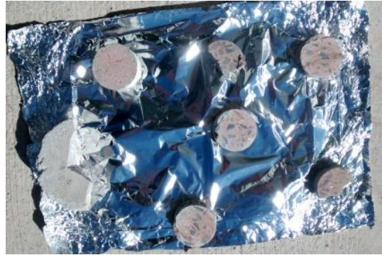
Figura 5.5 Concreto manchado con pintura textil color rojo carmesí a una concentración de 25 ppm después de estar expuesto al sol durante 2 horas (Tiempo 2 hr)
