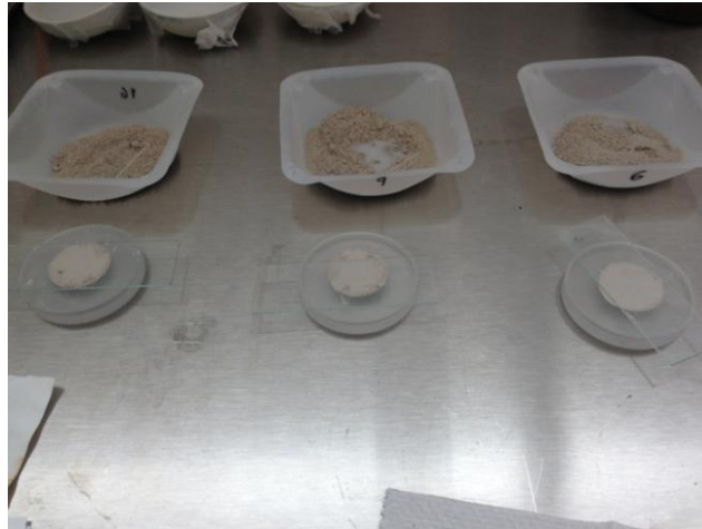
Figura 4.21 Obtención de muestras en polvo de la superficie de los cilindros de concreto.
