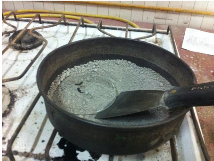
Figura 4.1 Secado de agregado fino para obtención de los testigos de humedad
