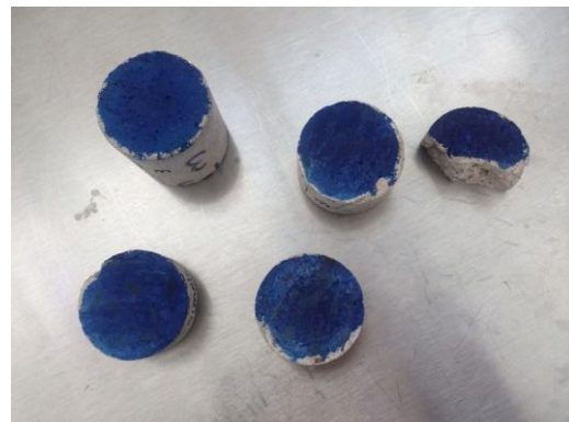
Figura 4.29 Manchado de concreto con azul de metileno.
