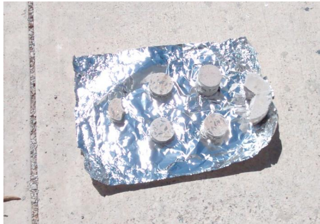
Figura 4.25 Exposición de concreto a la radiación solar primera etapa (25 ppm).
