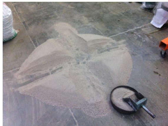
Figura 4.3 Proceso de cuarteo del agregado fino.
