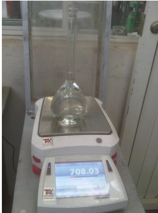
Figura 4.2 Calibración del matraz.
