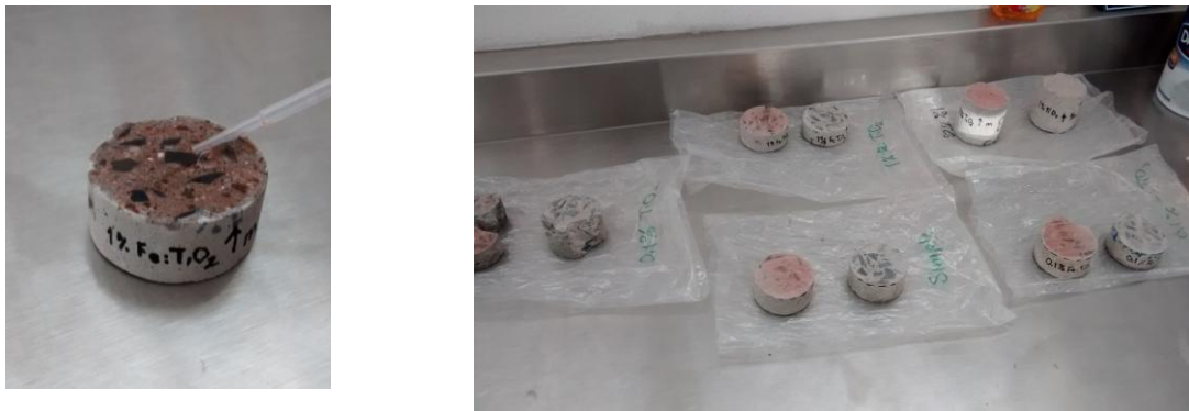
Figura 4.23 Manchado de concreto con pintura vegetal color rojo carmesí primera etapa (25 ppm).
