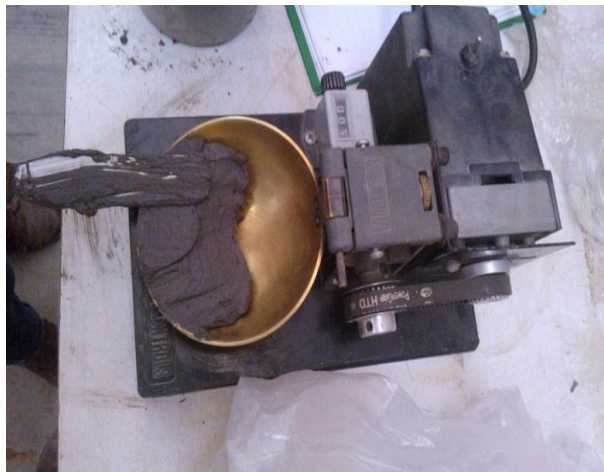
Figura 3-3. Colocación del material saturado en la Copa de Casagrande.
