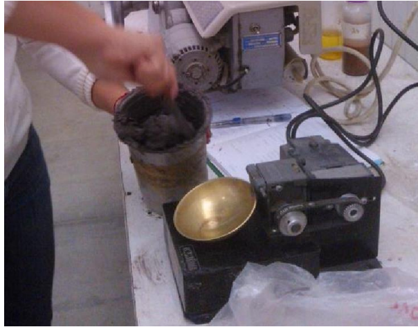
Figura 3-2. Homogenización del material saturado para ser vertido en la Copa de Casagrande.
