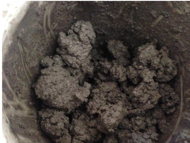
Figura 4-1. Suelo contaminado con gasolina.
