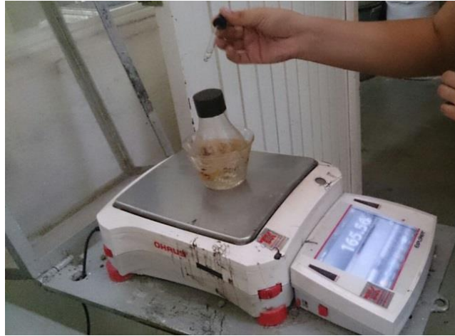
Figura 3-4. Determinación de la cantidad máxima de diésel retenida por el espécimen.
