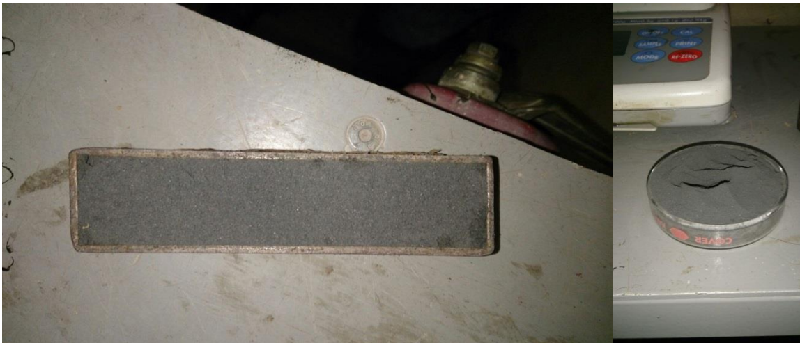
Figura 4-2. Ausencia de la contracción lineal y del límite de contracción del suelo contaminado con diésel.
