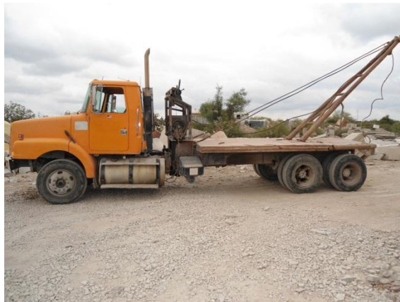
Figura 4-8 Grúa para carga de bloques de mineral.
