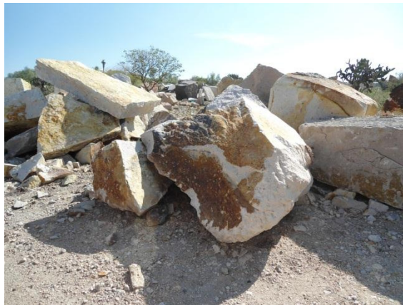
Figura 1-4 Bloque producido mediante la extracción con pólvora.
