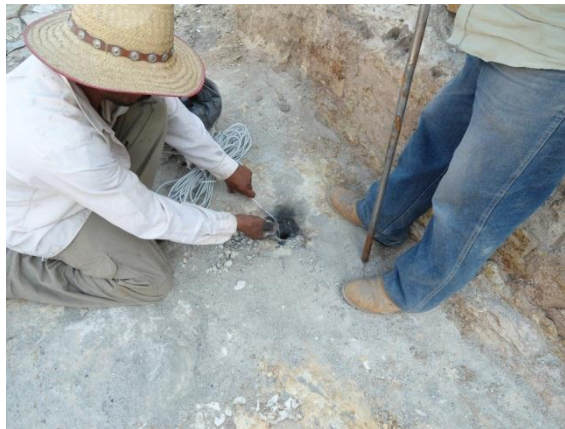
Figura 1-6 Proceso de extracción con pólvora y cuñas.
