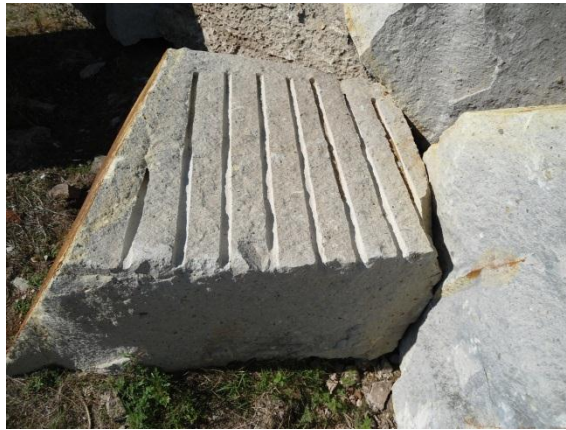
Figura 1-5 Bloque producido mediante la extracción con agente expansivo.
