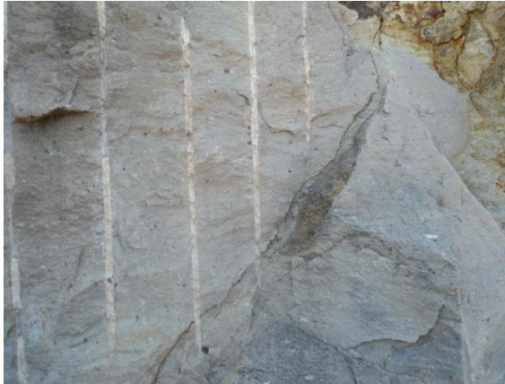
Figura 4-7 Extracción con Agente Expansivo.
