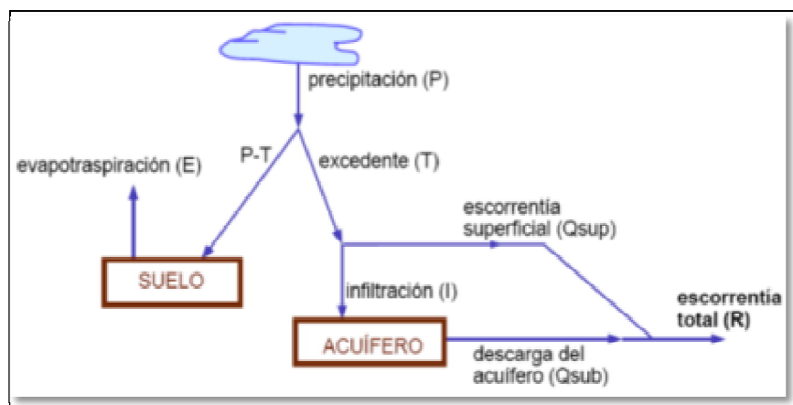
Figura 3.18. Descripción esquemática del flujo de agua en el Modelo Hidrológico de Témex
