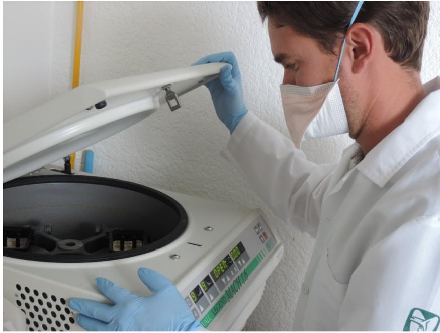
Figura 1. Centrifugación de leche bronca como paso previo al cultivo en medios enriquecidos para el aislamiento de *M. bovis*.
