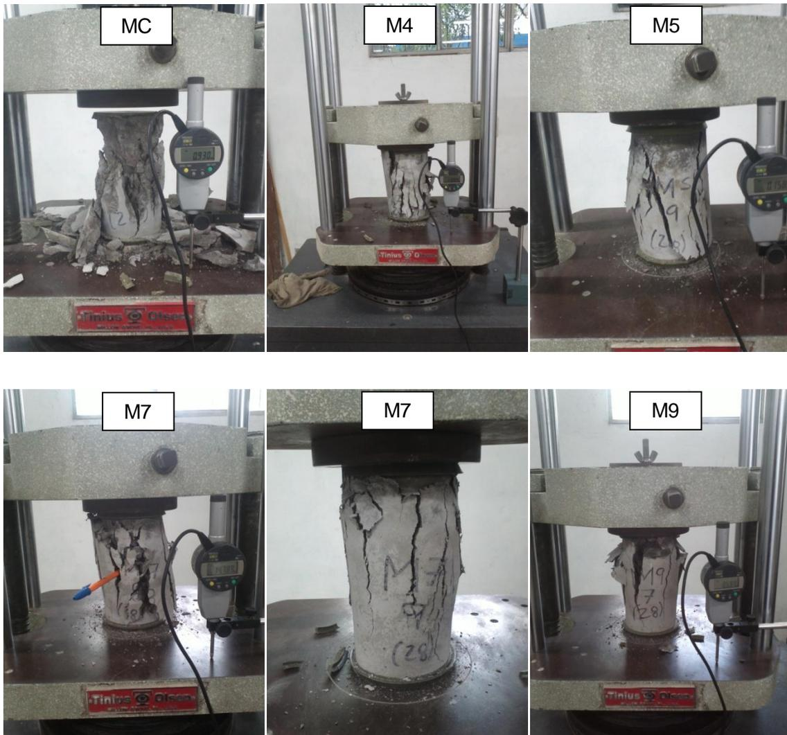
Figura 4.17 Patrones de falla de los cilindros de concreto en la prueba de compresión a 28 días.
