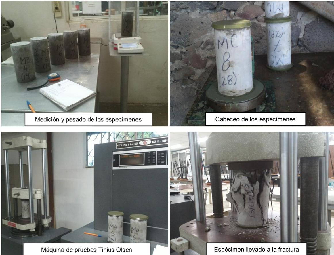
Figura 3.13 Cilindros de concreto en la prueba de compresión.
