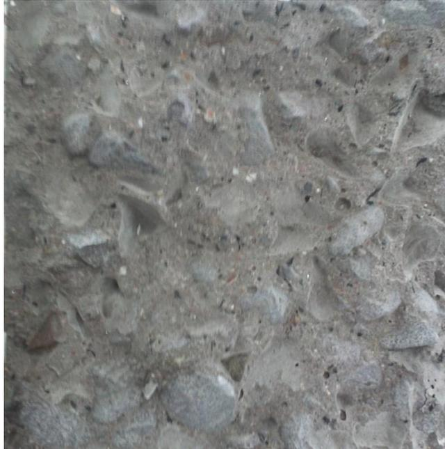
Figura 2.2 Macroestructura de una muestra de concreto.
