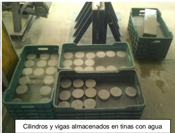
Figura 3.10 Elaboración y curado de los especímenes de prueba.
