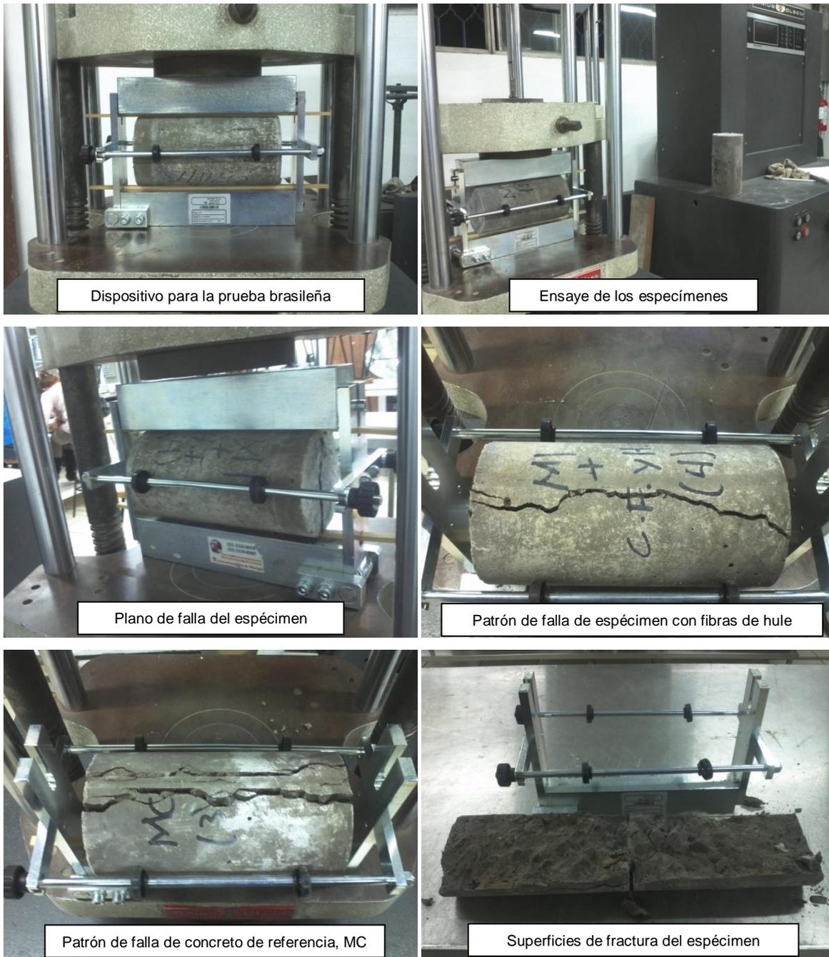
Figura A.3 Cilindros de concreto en la prueba de tensión indirecta.
