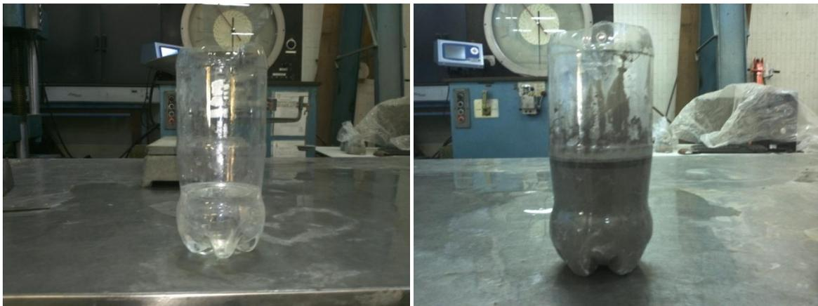
Figura A.2 Tratamiento de la ceniza volante con NaOH.
