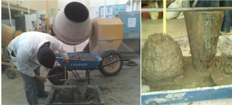
Figura 3.11 Prueba de revenimiento en el concreto.
