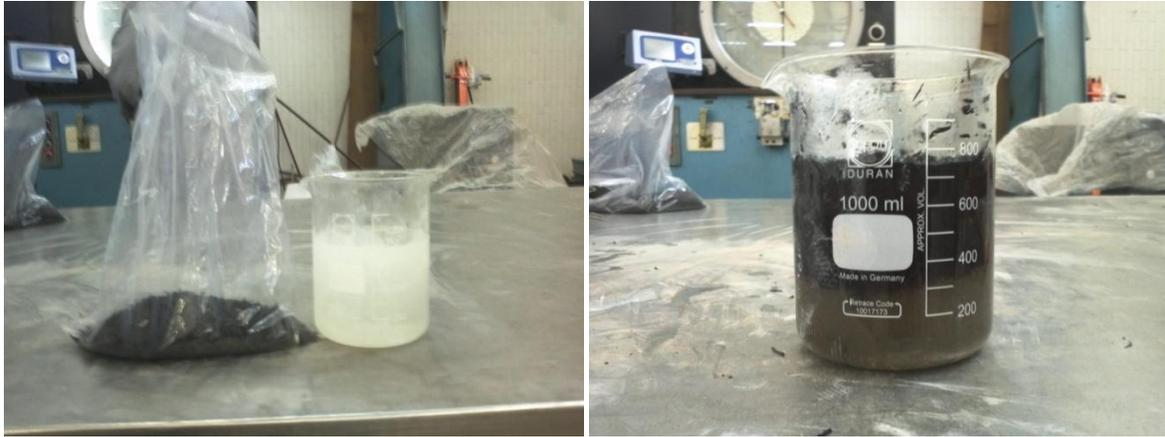
Figura A.1 Tratamiento del hule reciclado de neumáticos con NaOH.
