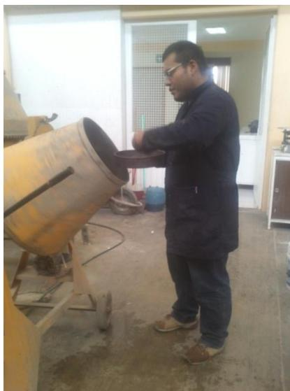
Figura 3.9 Adición de hule reciclado de neumáticos a la mezcla de concreto.
