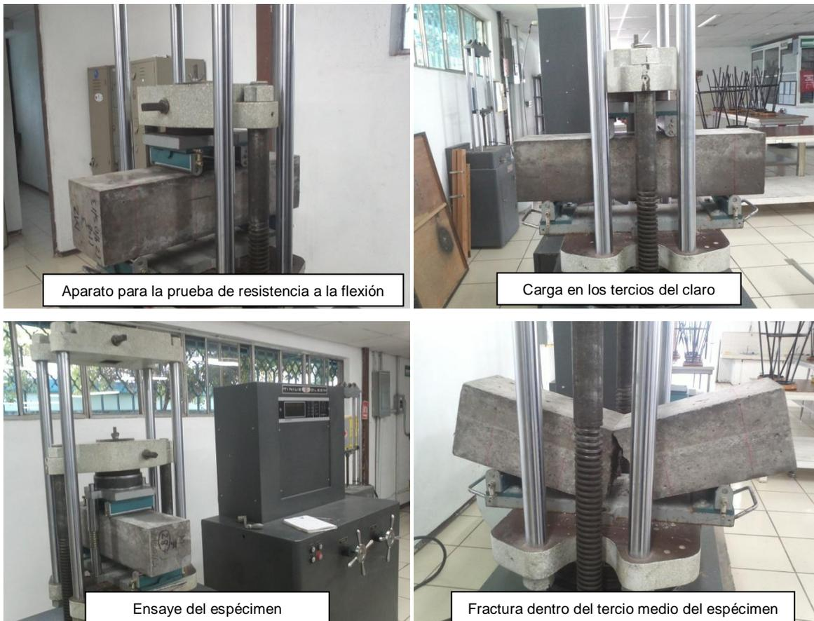
Figura 3.14 Vigas de concreto en la prueba de flexión.
