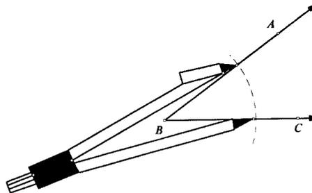
6. Con la misma abertura de compás del ángulo medido, se traza un arco haciendo centro en el punto de cruce del primer arco y del rayo, de tal forma que ambos arcos se crucen en un punto  $P$ .
