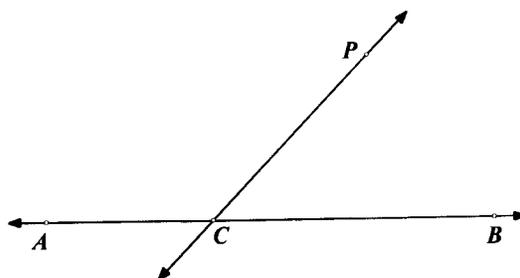
3. Se copia el ángulo  $\angle PCB$ , en el punto  $P$  de la secante. El segundo lado del ángulo en  $P$  será entonces la paralela a la recta inicial.
