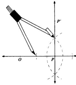
3. Se traza el segmento  $\overline{OP'}$ , el cual por el teorema de Pitágoras tendrá una longitud de  $\sqrt{2}$ .
