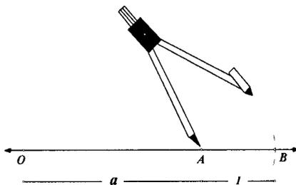
3. Se traza una circunferencia cuyo diámetro sea  $OB$  y se levanta una perpendicular al diámetro en el punto  $A$ , de tal manera que la recta perpendicular y la circunferencia
