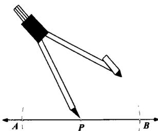
3. Haciendo centro en los puntos  $A$  y  $B$  respectivamente y con una abertura de compás mayor a la mitad del segmento  $AB$ , se trazan arcos por arriba y por debajo de la recta, de tal manera que los arcos se crucen en los puntos  $C$  y  $D$ .
