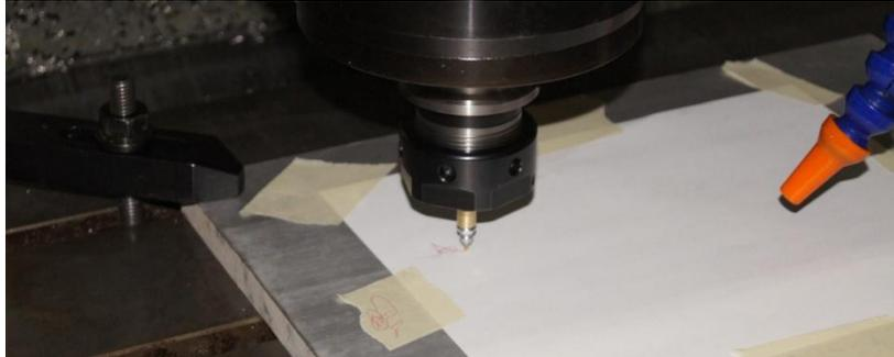
**Figura 4.6** Trazador colocado en el husillo del centro de maquinado.
