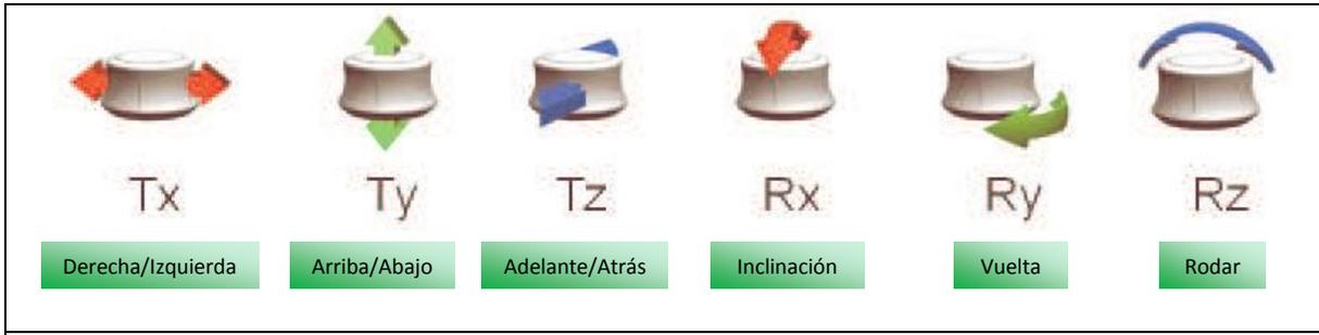
**Figura 2.28 Orientación de los ejes de rotación y traslación del mouse 3D. (Bonk)**
