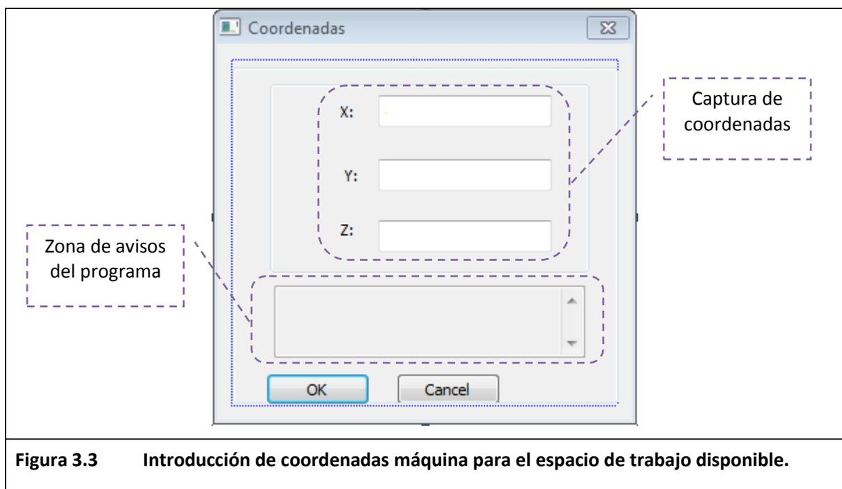
**Figura 3.3** Introducción de coordenadas máquina para el espacio de trabajo disponible.
