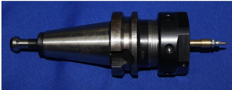
**Figura 4.5**      **Porta herramientas con trazador y plumilla.**
