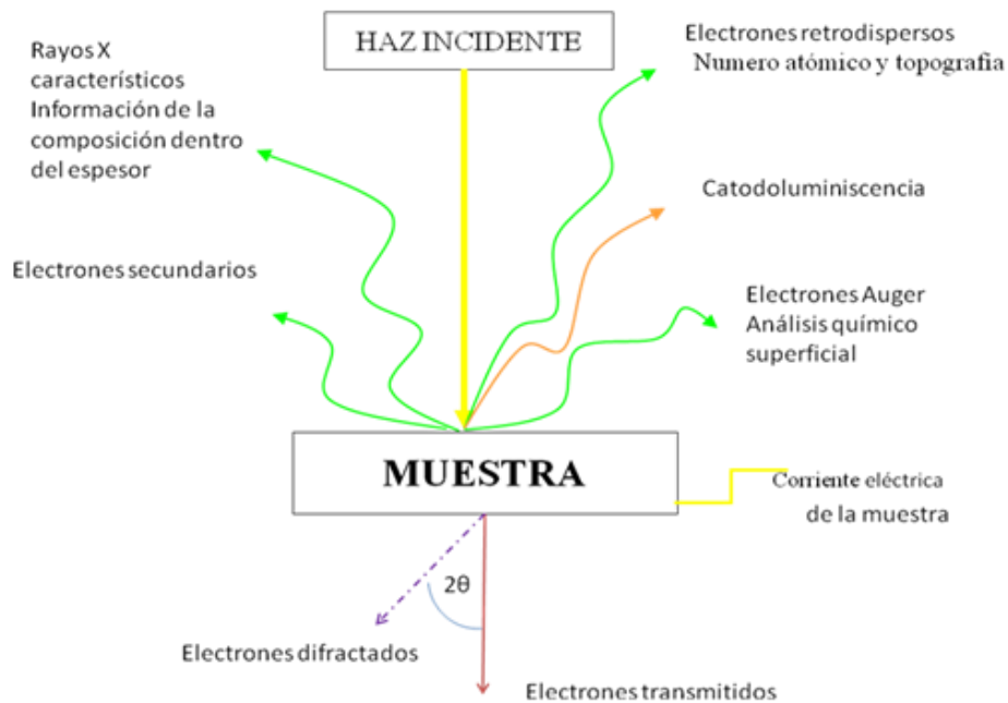
Figura 8-1 Señales generadas por la interacción del haz de electrones con la muestra
