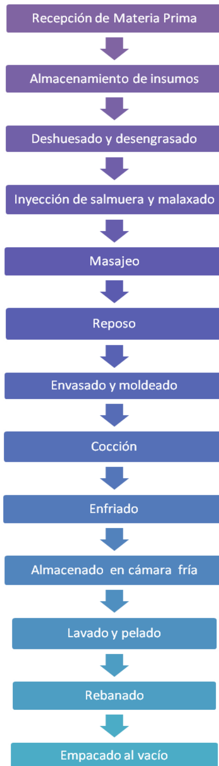
Figura 1. Diagrama de flujo del proceso de elaboración de jamón cocido rebanado.
