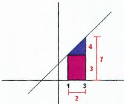
Área = Área del rectángulo + Área del triángulo
