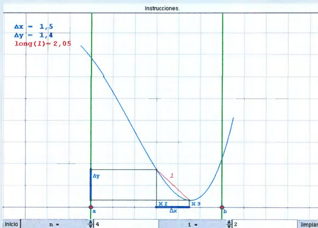
Para  $n=1$ , una aproximación a la curva es la longitud del segmento que inicia en  $(a, f(a))$  y termina en  $(b, f(b))$ . Dados los incrementos en  $x$  y en  $y$ , entonces la longitud del segmento es  $L$  y por el teorema de Pitágoras se tiene  $L = \sqrt{\Delta x^2 + \Delta y^2}$ .
