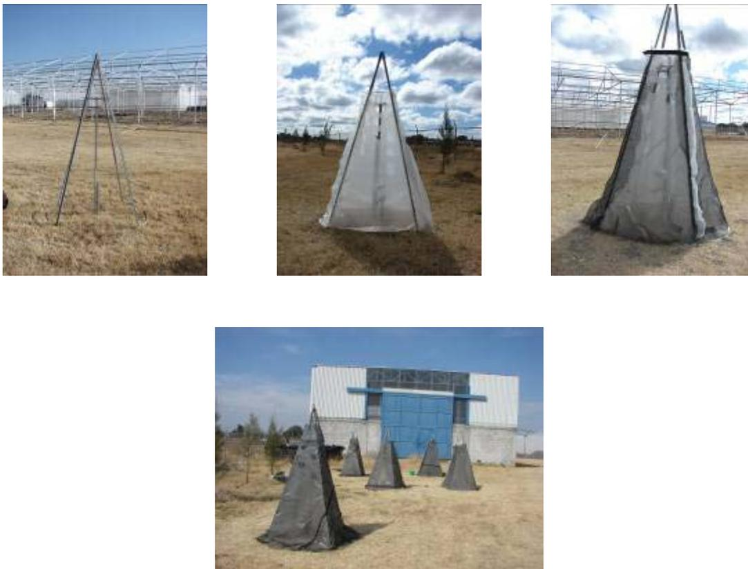
**Figura 6.6.** Estructuras en forma de pirámide truncada empleadas en el experimento.
