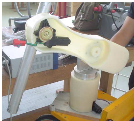
Figura 102. Ensamble mecánico del la base y el brazo del robot.
