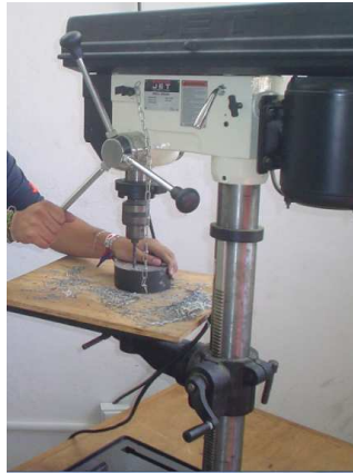
Figura 105. Manufactura del contrapeso de hierro.
