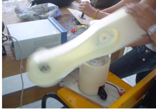
Figura 103. Movimiento de prueba del brazo con voltaje de fuente regulada.
