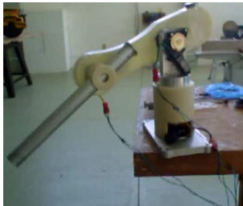
Figura 104. Conexiones provisionales para validar movimientos del robot.
