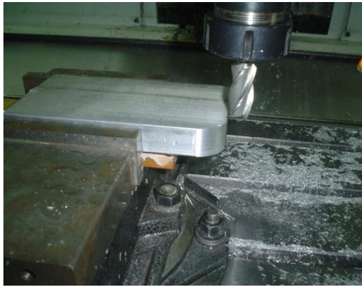
Figura 100. Desbaste de la pieza de aluminio, a) Manufactura del eje de aluminio del brazo en CNC, b) Pieza de aluminio terminada después de ser tratada en CNC.
