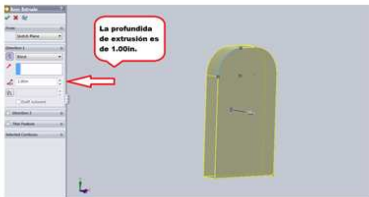
Figura 64. Extrusión de perfil para convertir a sólido.
