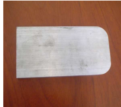
Figura 100. Desbaste de la pieza de aluminio, a) Manufactura del eje de aluminio del brazo en CNC, b) Pieza de aluminio terminada después de ser tratada en CNC.
