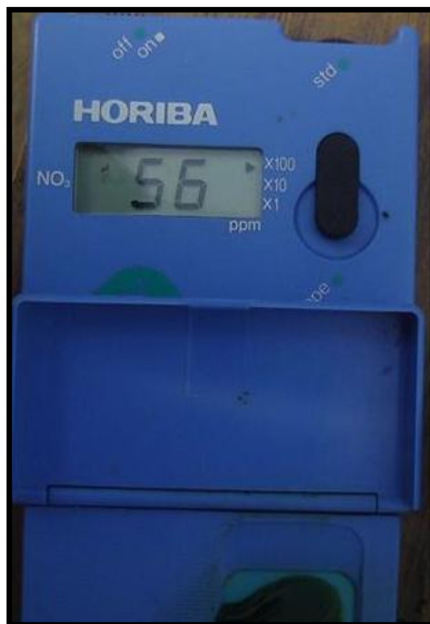
Figura 4.10. Medición del contenido de nitratos en hoja de lechuga. Equipo Compact Ion Meter Card Ion Modelo C-141
