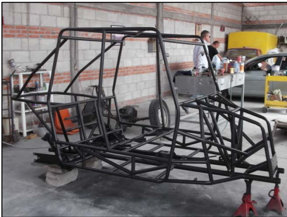
Fig. 81. Soldado y pintado del prototipo final antes del armado.
