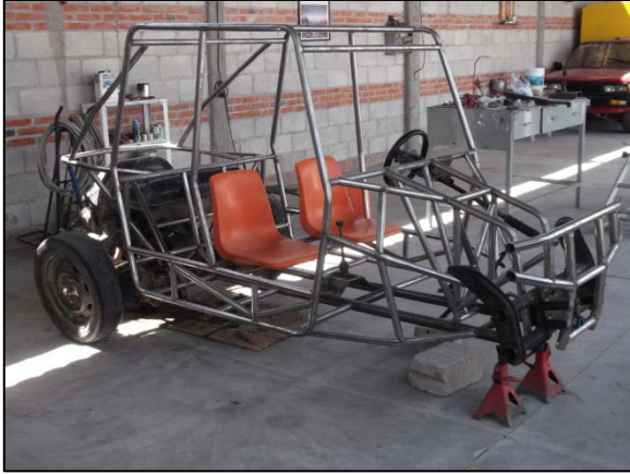
Fig. 80. Armado y punteado de la estructura y acomodo de las partes mecánicas.
