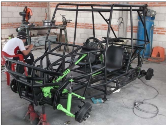
Fig. 81. Soldado y pintado del prototipo final antes del armado.
