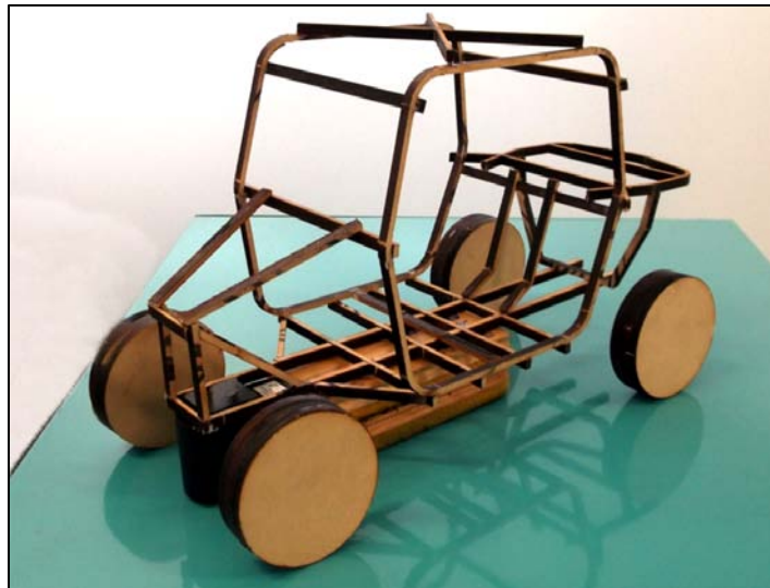
Fig. 65. Maqueta de verificación volumétrica del vehículo, etapa 6.
