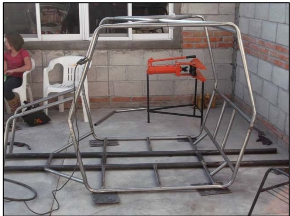
Fig. 79. Armado de largueros y laterales primarios de la estructura.
