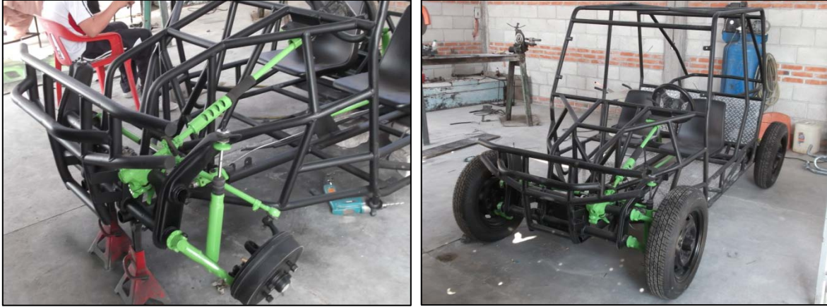
Fig. 82. Armado final del prototipo con sus componentes mecánicos e instalación de laminado para el piso.
