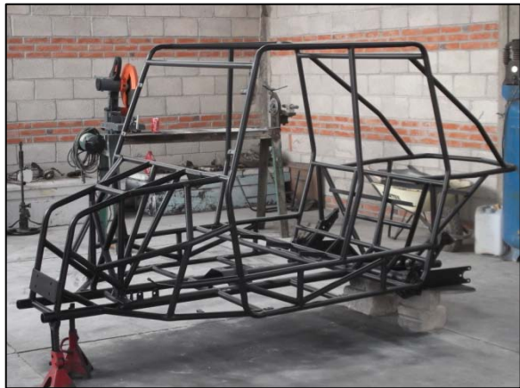
Fig. 81. Soldado y pintado del prototipo final antes del armado.
