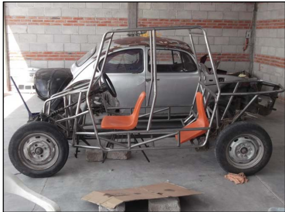
Fig. 80. Armado y punteado de la estructura y acomodo de las partes mecánicas.
