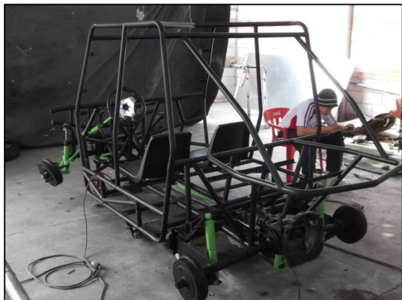
Fig. 81. Soldado y pintado del prototipo final antes del armado.
