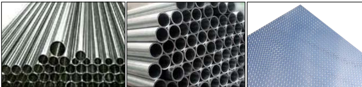
Fig. 76. Materiales utilizados: Tubo C14, Tubo Cedula 30 y lámina de aluminio anti-derrape.
