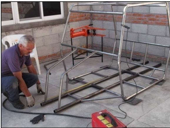
Fig. 79. Armado de largueros y laterales primarios de la estructura.
