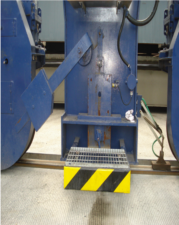
6 Figura 2.2.4 □A, 2.2.4-B Sistema mecánico de anclaje y anti huracanes
