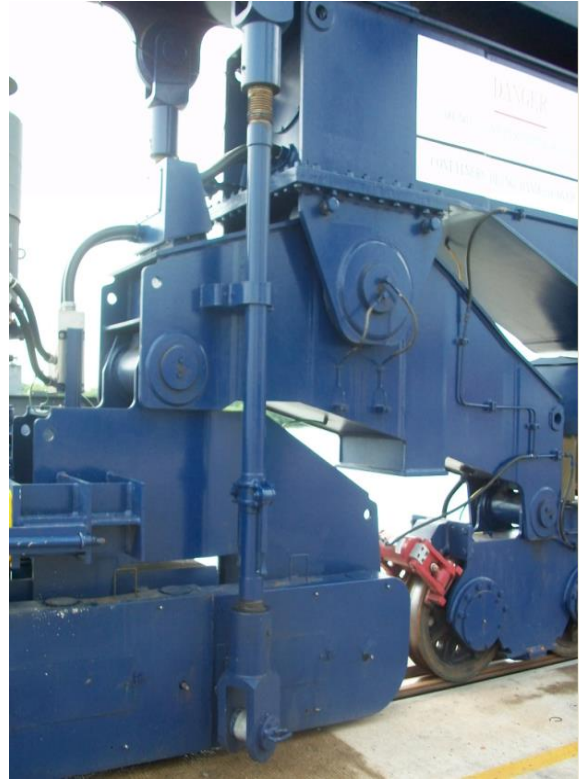
6 Figura 2.2.4 □A, 2.2.4-B Sistema mecánico de anclaje y anti huracanes
