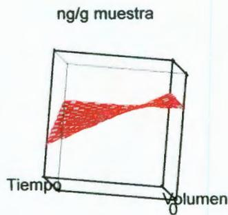
Superficie de respuesta entre volumen de solvente y tiempo de extracción de Floureno por sonicación.
