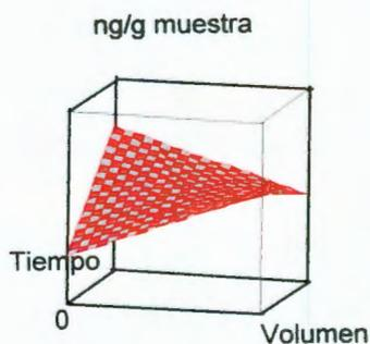
Superficie de respuesta entre volumen de solvente y tiempo de extracción de B(a)Antraceno por sonicación.
