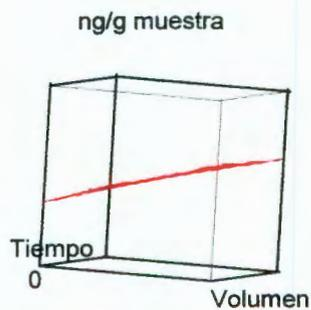
Superficie de respuesta entre temperatura, volumen de solvente y tiempo para la extracción de B(b)Fluoranteno en microondas.
