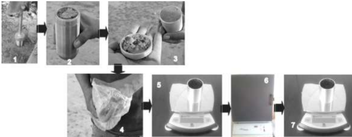
Figura 40 Procedimiento para la toma de muestras en campo y laboratorio para determinar densidad aparente del suelo.
