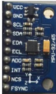
Figura 4. 1. Sensor MPU-9250 marca InvenSense.
