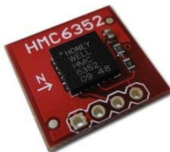
Figura 2. 7. Magnetómetro electrónico.
