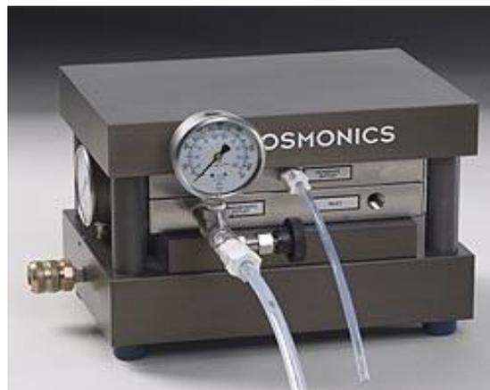
**Figura 7.** Unidad de membrana (SEPA CF II, Osmonics) utilizada para la separación de ácido láctico.
