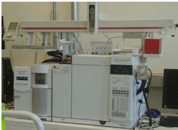
Figura 8. Cromatógrafo de Gases con Olfactometría.
